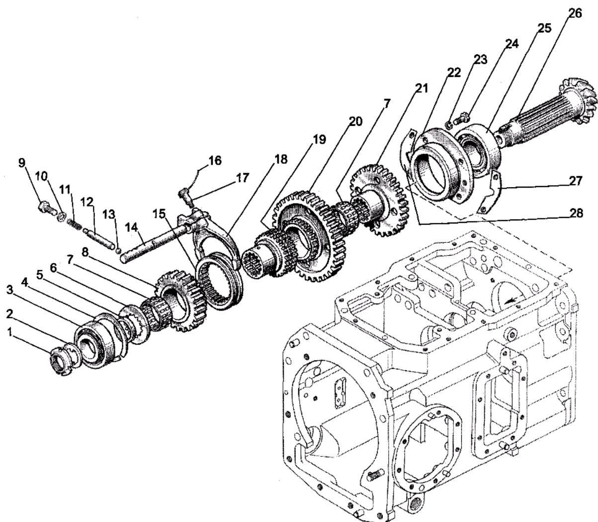
Рис. 17.3. Коробка передач. Вал вторичный
