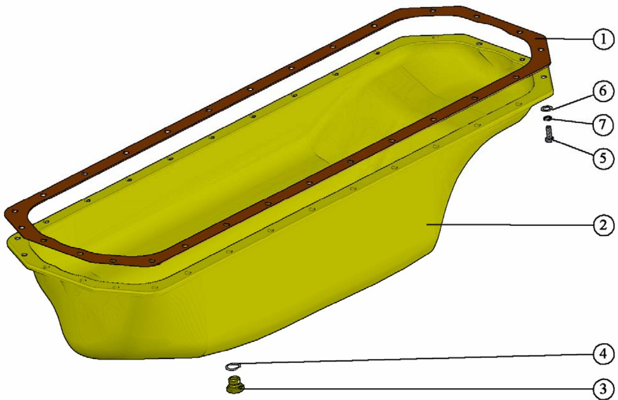
Рис. 14 Установка картера масляного.
