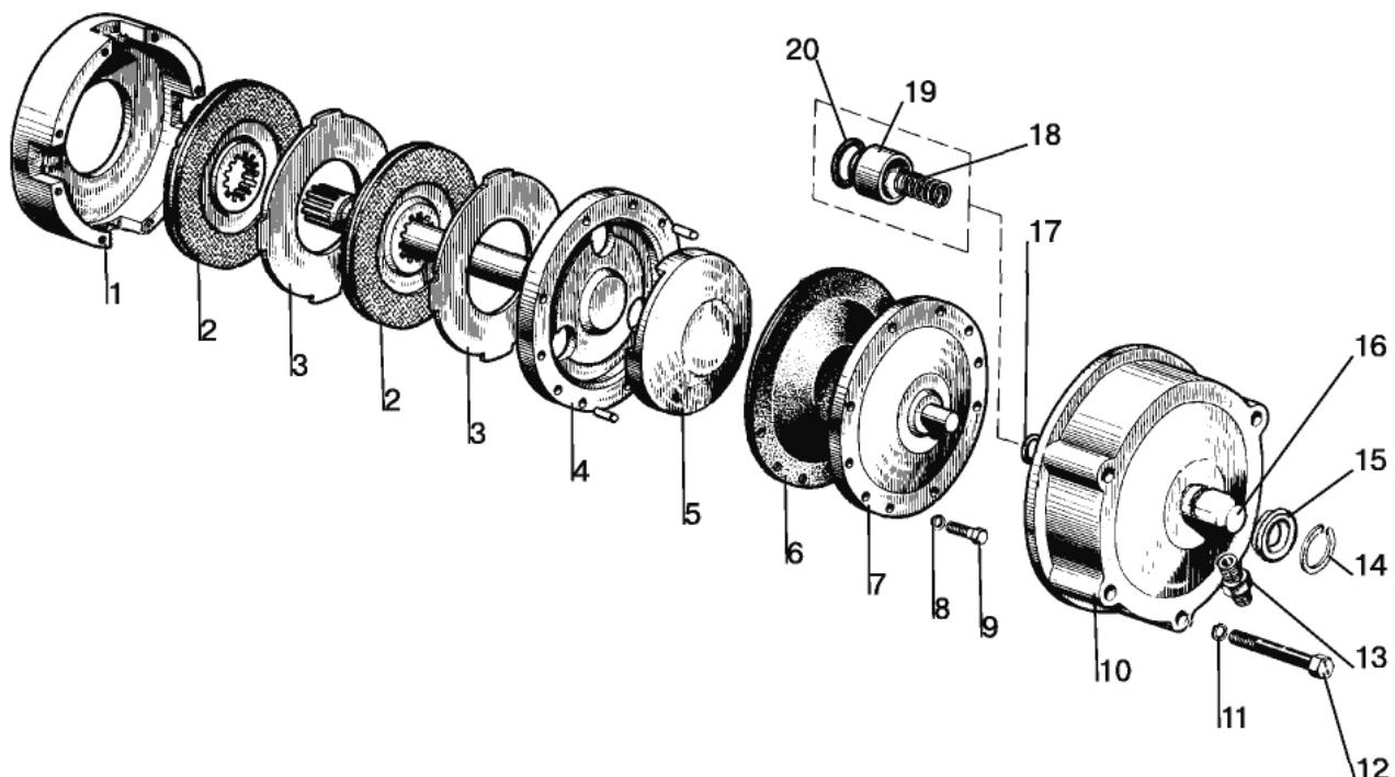
Рис. 24.3. Механизм блокировки дифференциала
