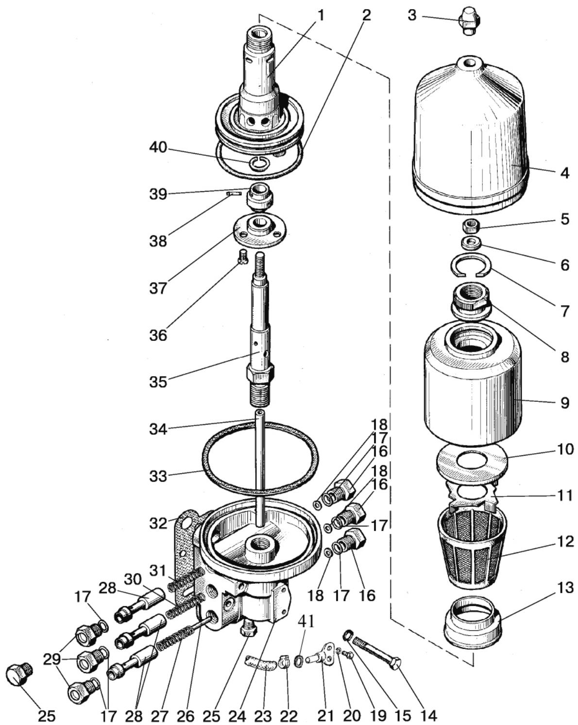
Рис. 17.17. Фильтр-распределитель
