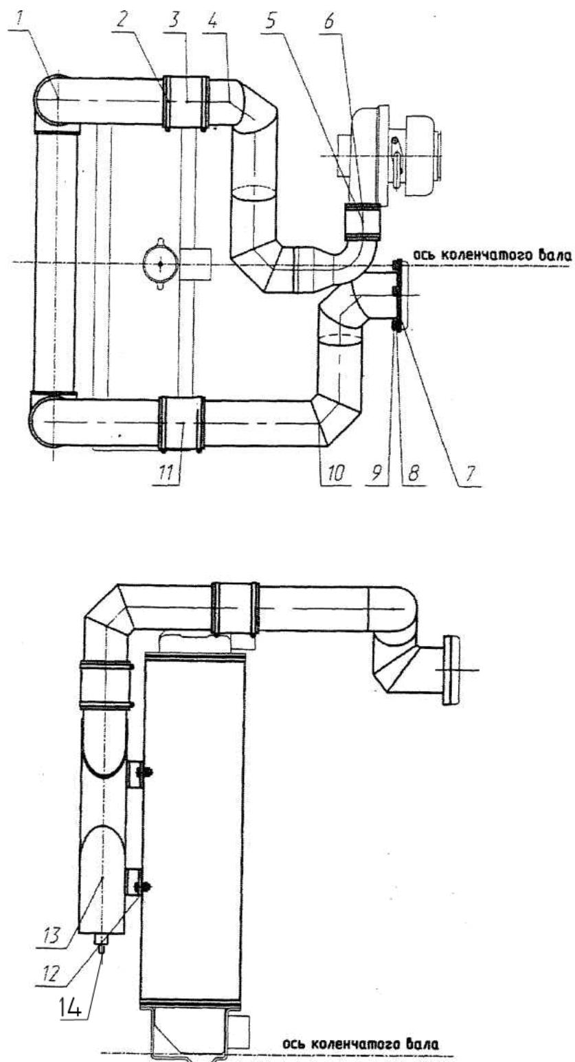
Рис. 13.3 Установка охладителя (для трактора «БЕЛАРУС-1221.3/1221В.3»)
