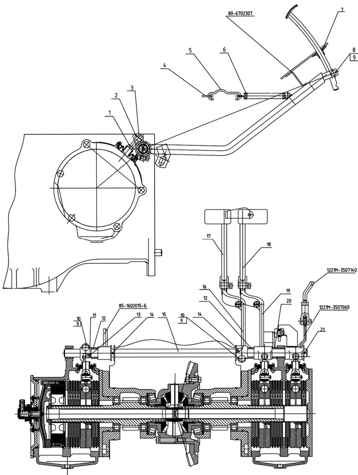
Рис. 35.4. Управление «мокрыми» тормозами
