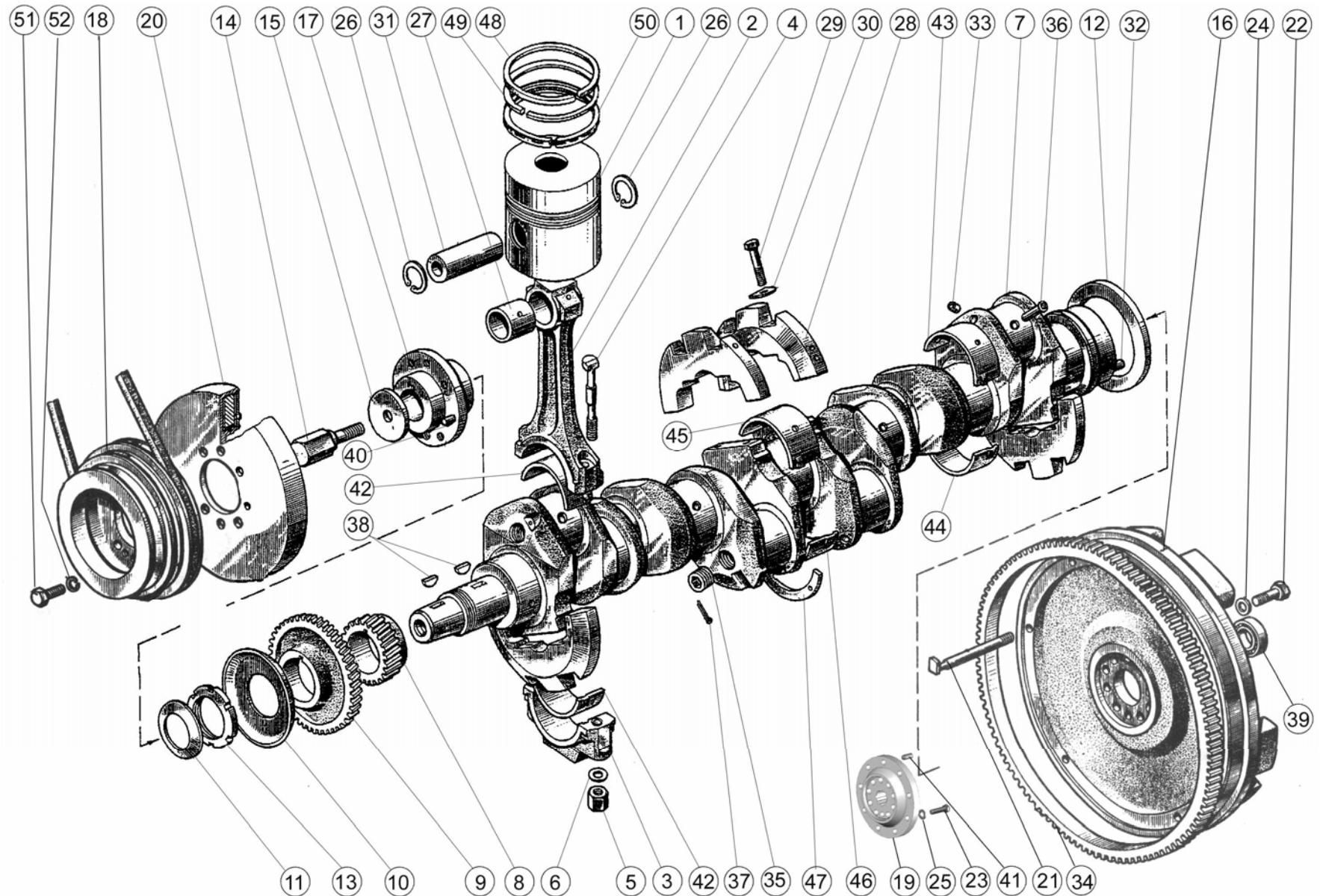
Рисунок 4. Поршни и шатуны. Коленчатый вал и маховик.
