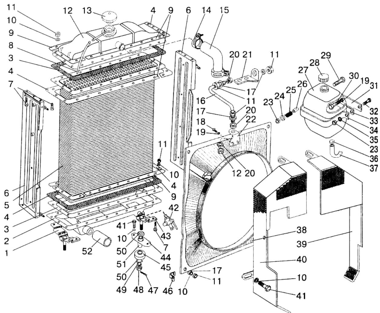
Рис. 13.2 Радиатор водяной (для трактора «БЕЛАРУС-1221.3/1221В.3»)
