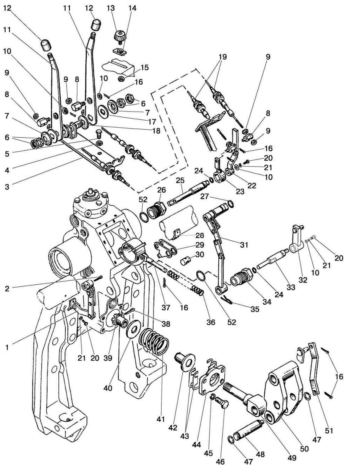
Рис. 46.15. Гидроподъемник. Управление гидроподъемником
