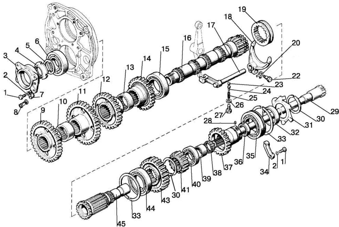
Рис. 17.4. Коробка передач. Вал промежуточный
