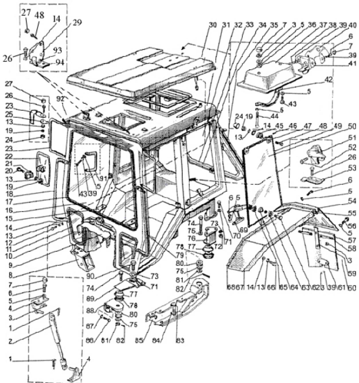
Рис. 67.1. Кабина трактора
