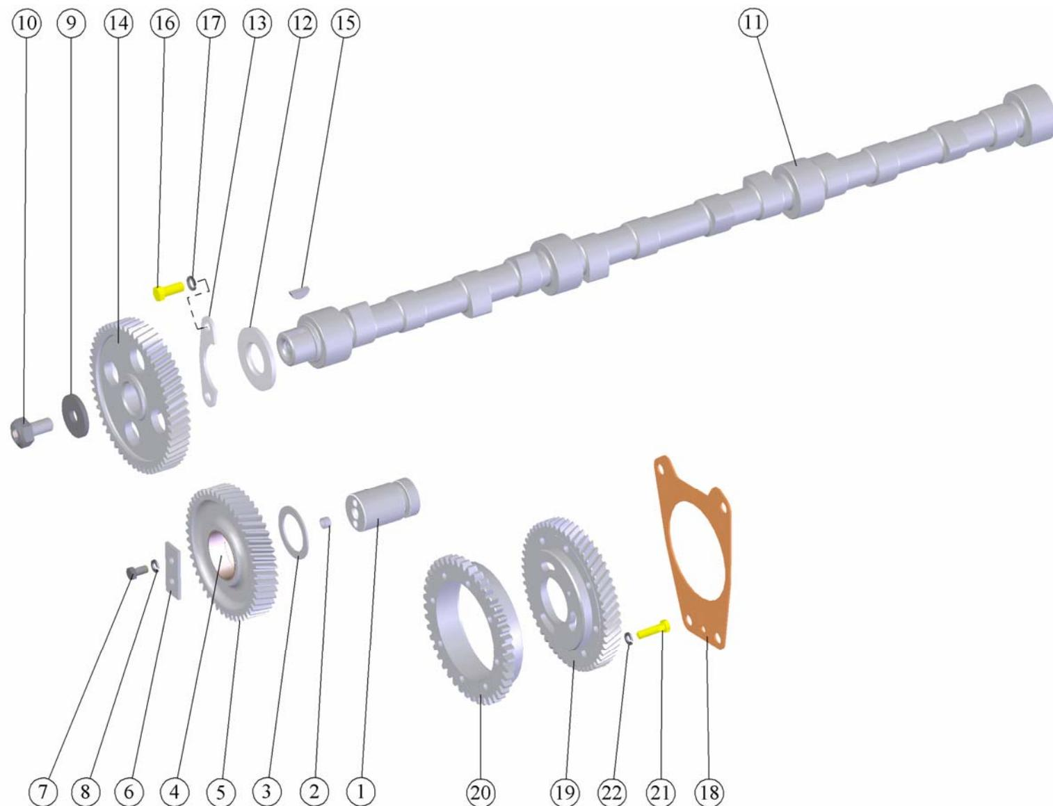
Рис. 5 Распределительный механизм.
