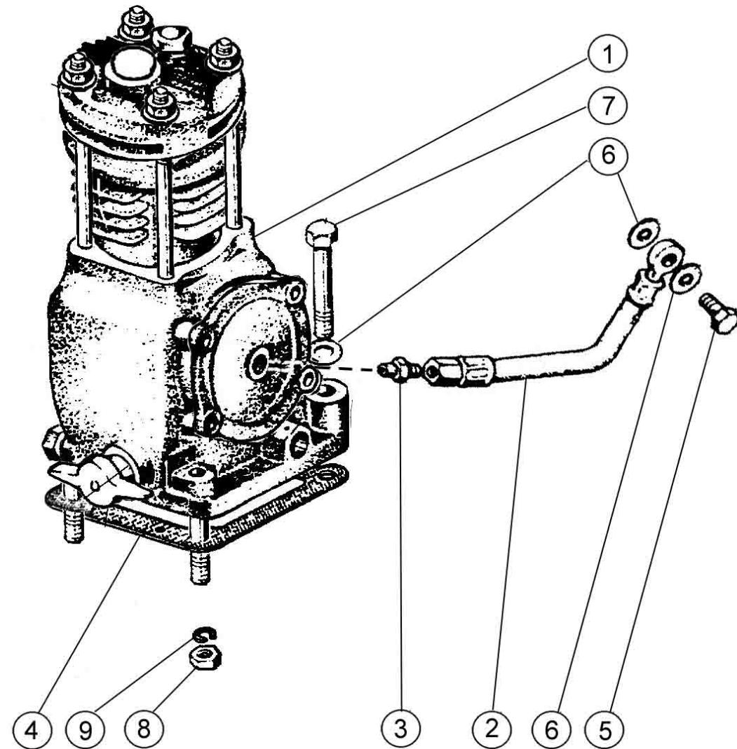
Рисунок 22. Установка пневмокомпрессора.
