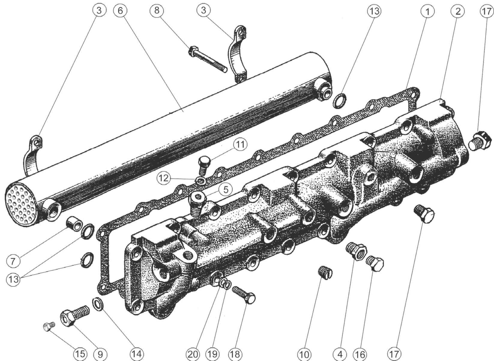
Рисунок 9. Установка теплообменника
