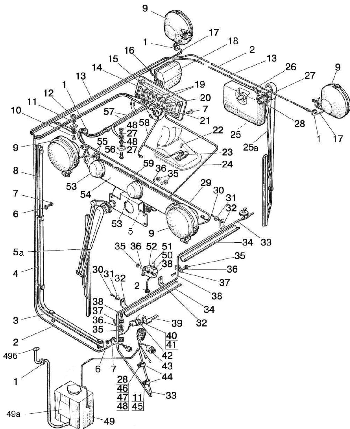
Рис. 37.3. Электрооборудование кабины. Фары рабочие и фонари задние
