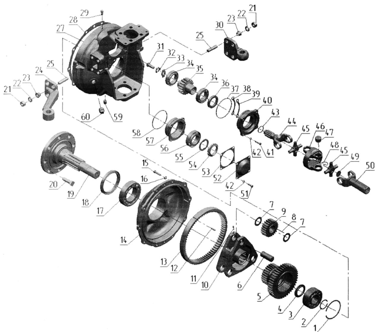
Рис. 23.4 Редуктор колесный.
