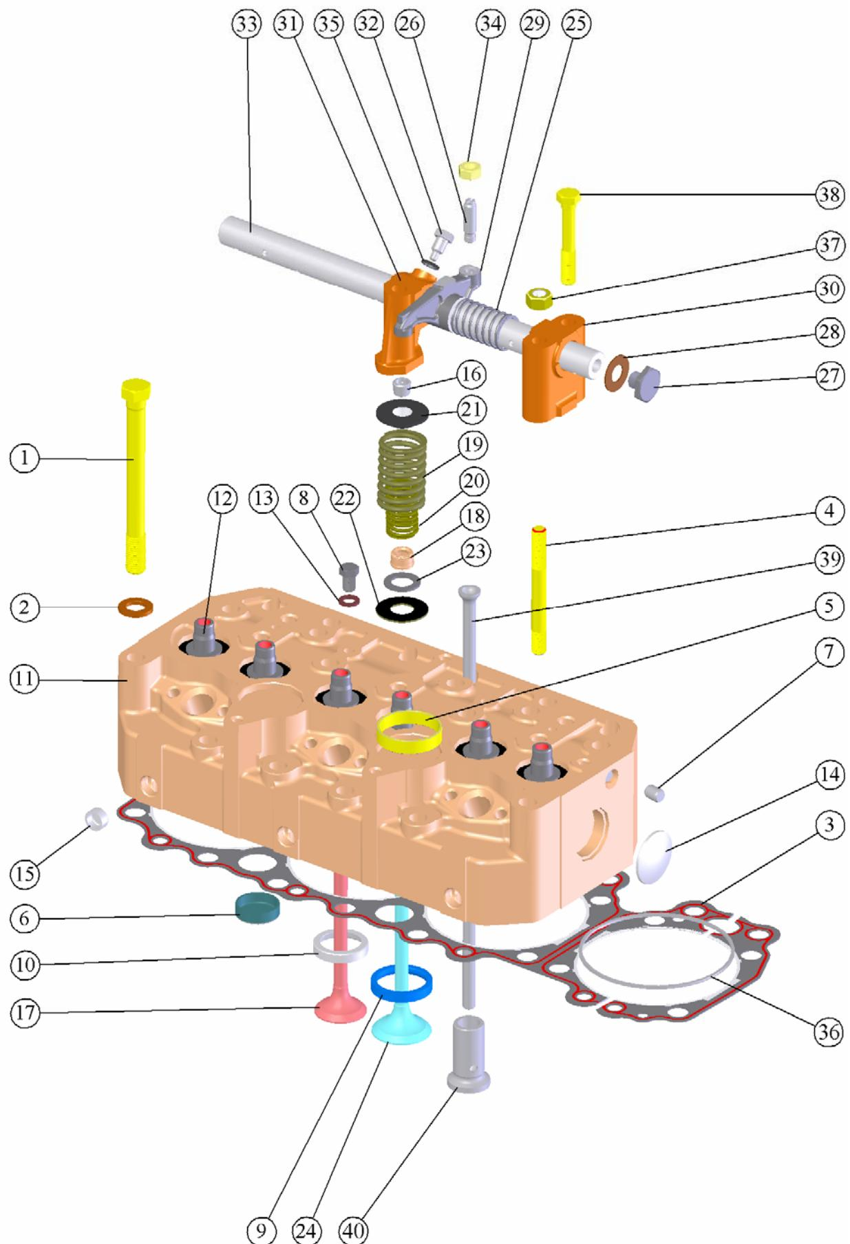
Рис. 2 Головка цилиндров. Клапаны и толкатели клапанов.
