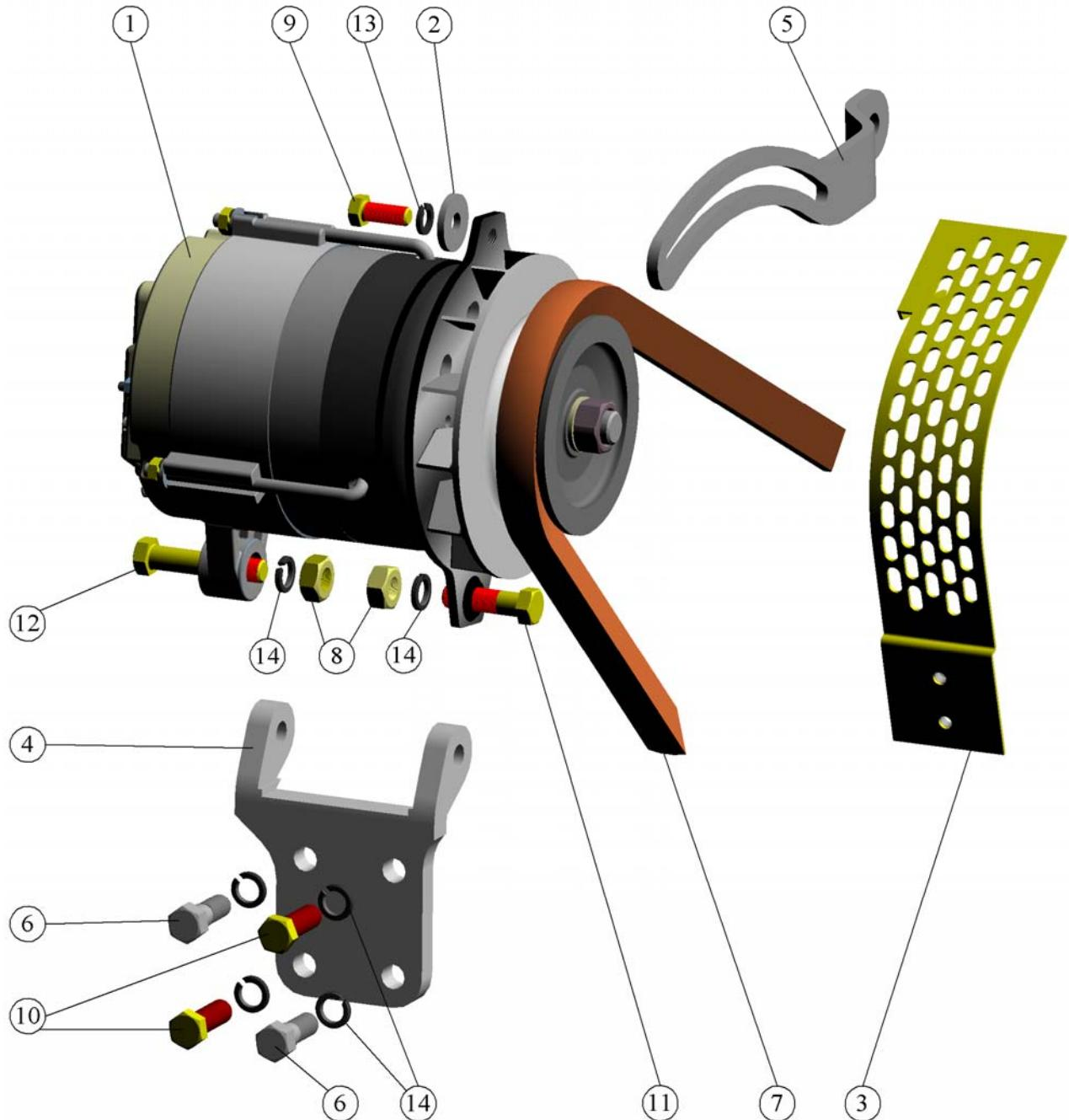
Рис. 23 Установка генератора.
