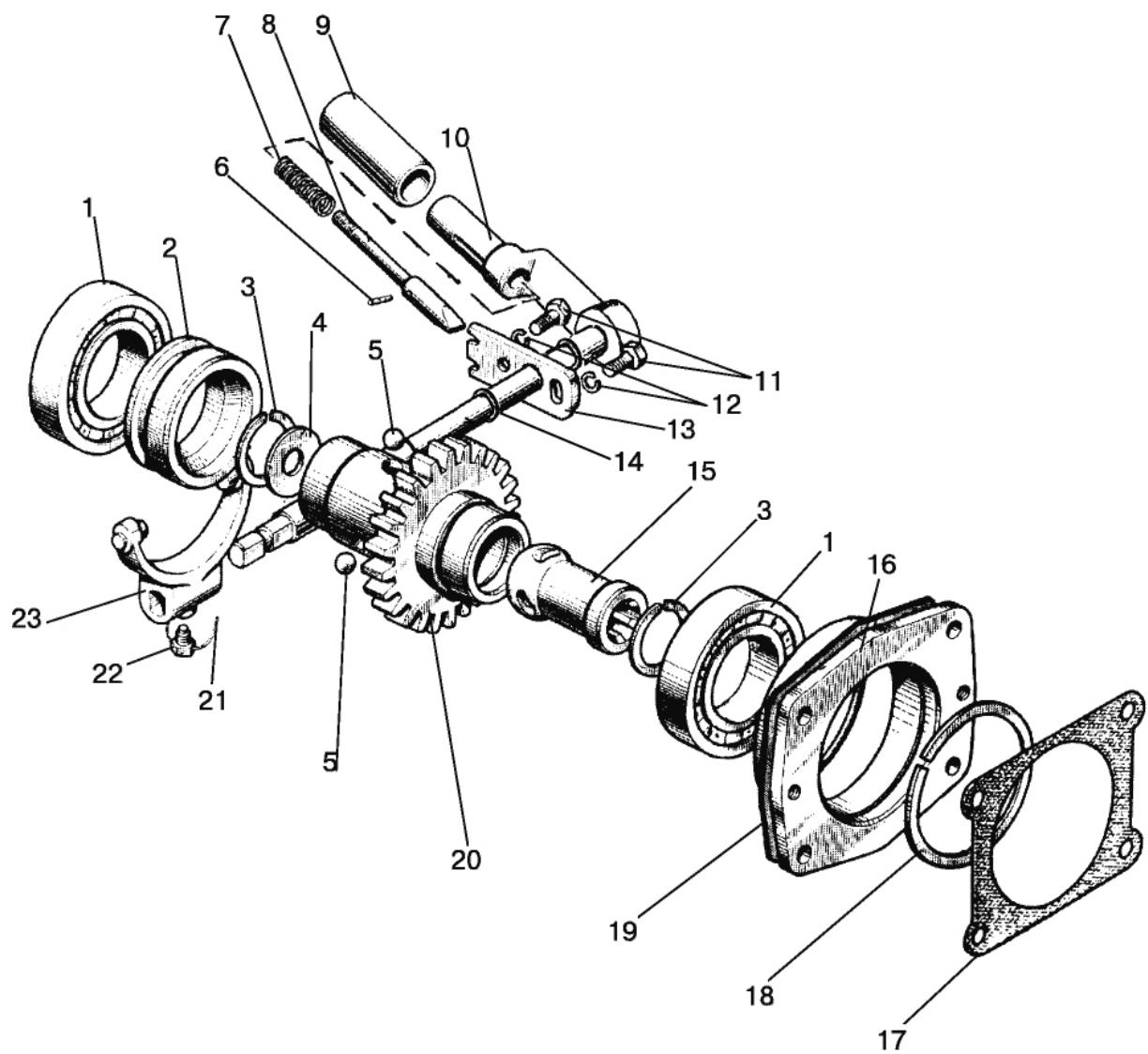
Рис. 46.1. Привод насоса
