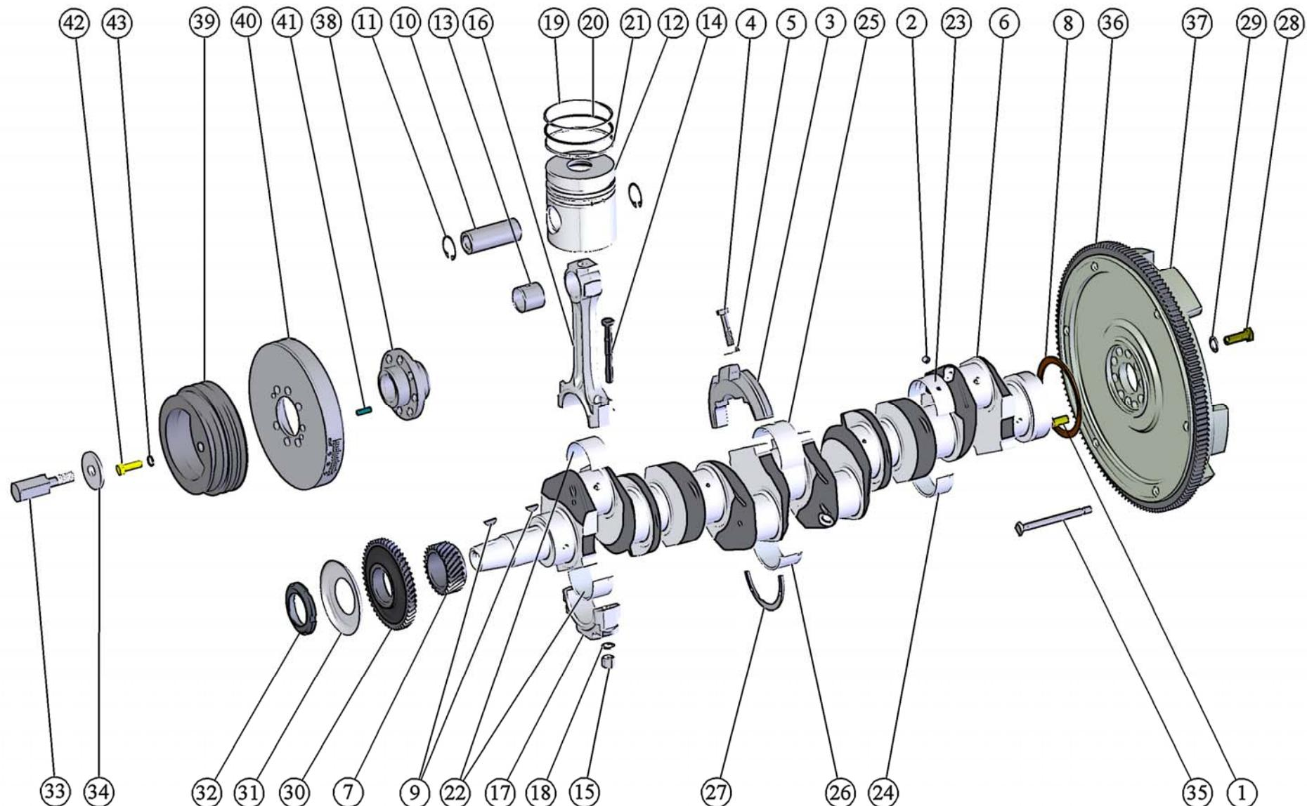
Рис. 4 Кривошипно-шатунный механизм. Установка шкива. Установка маховика.
