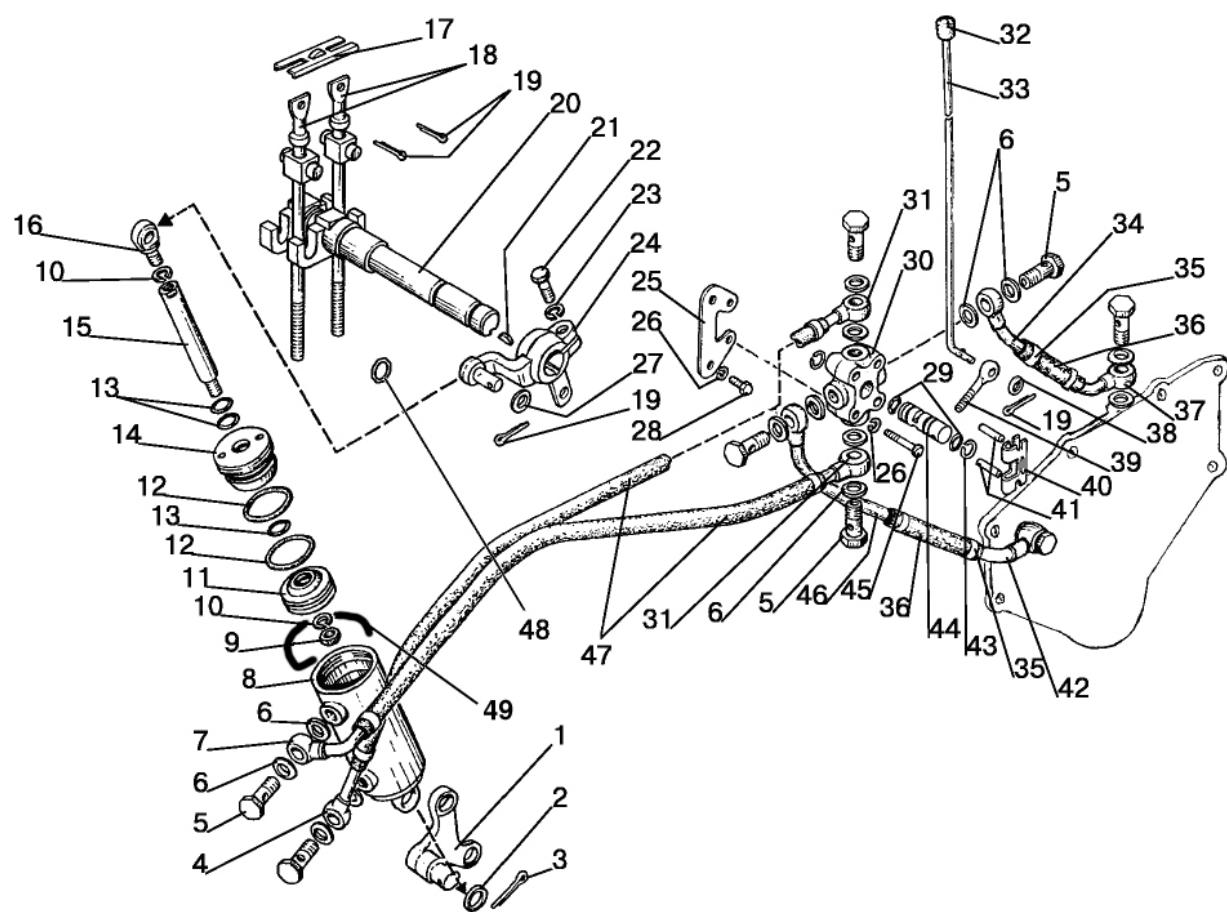
Рис. 42.5. Управление задним валом отбора мощности
