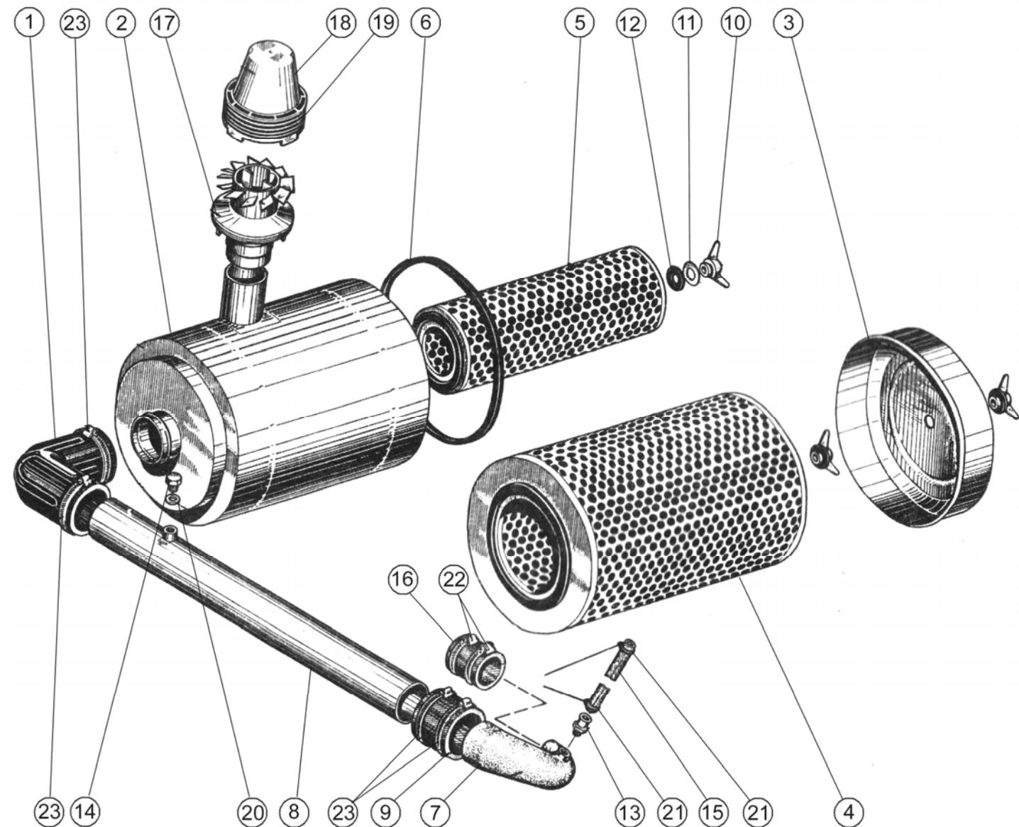
Рисунок 13. Воздухоподводящий тракт
