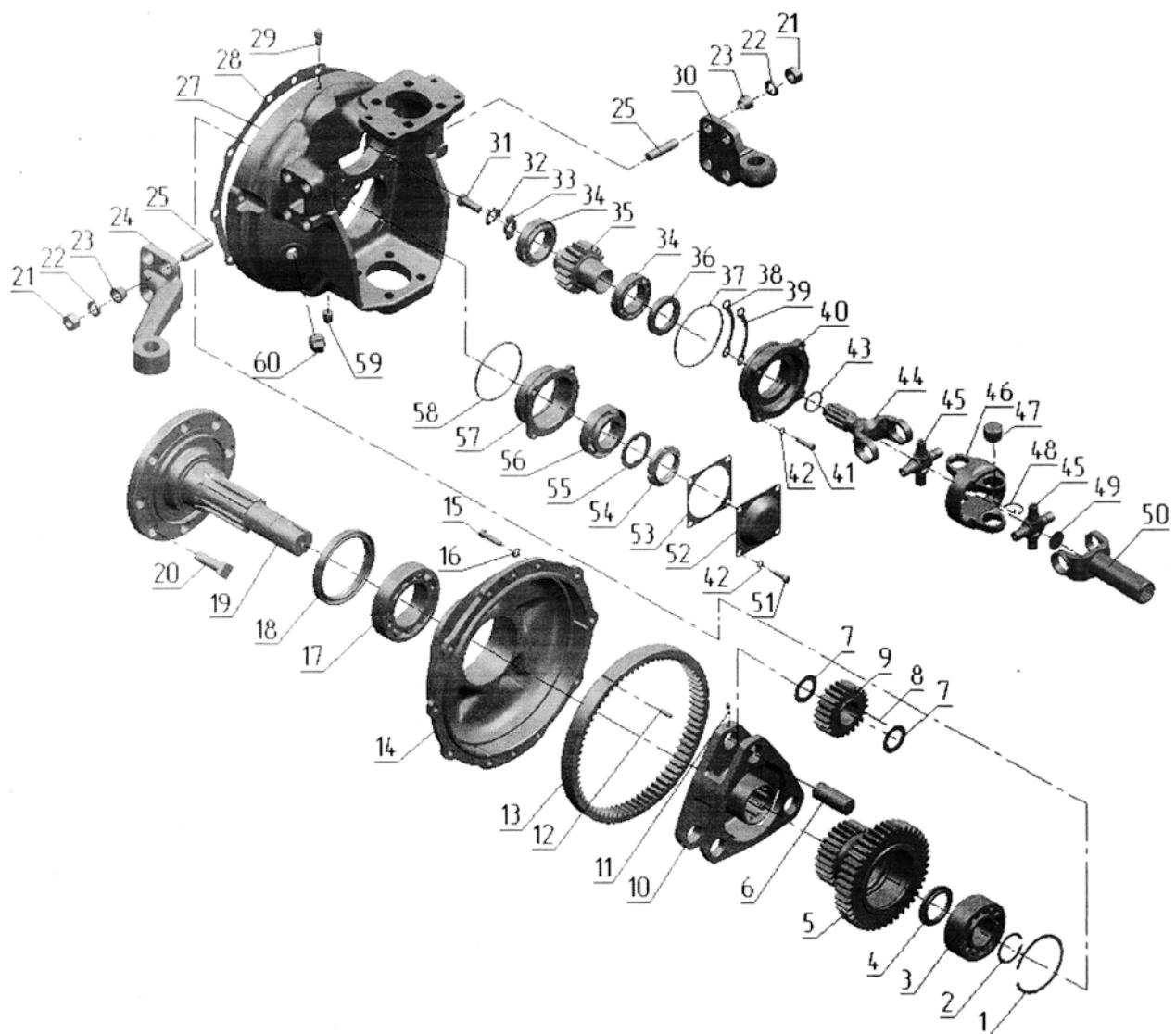
Рис. 23.4 Редуктор колесный.
