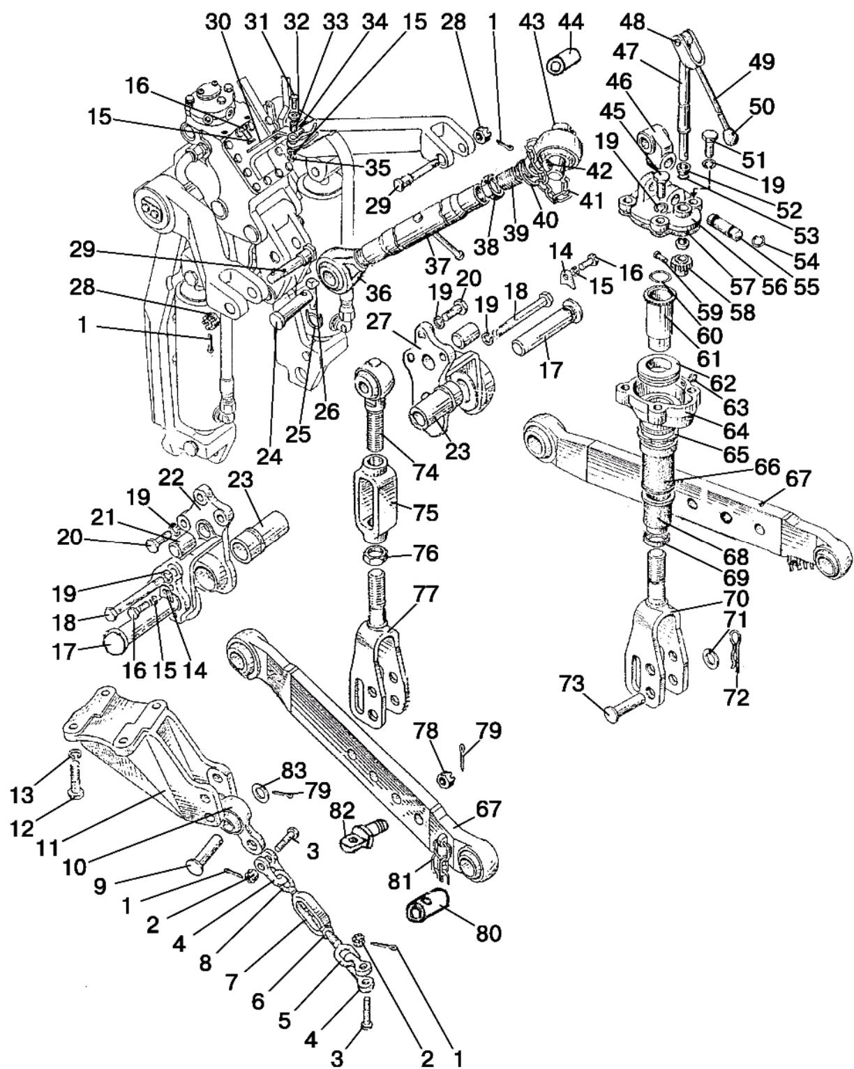
Рис. 46.2. Навесное устройство с гидроподъемником
