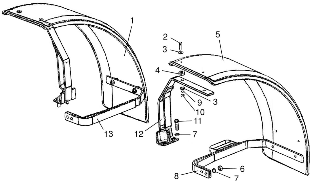
Рис. 84.4. Крылья передних колес
