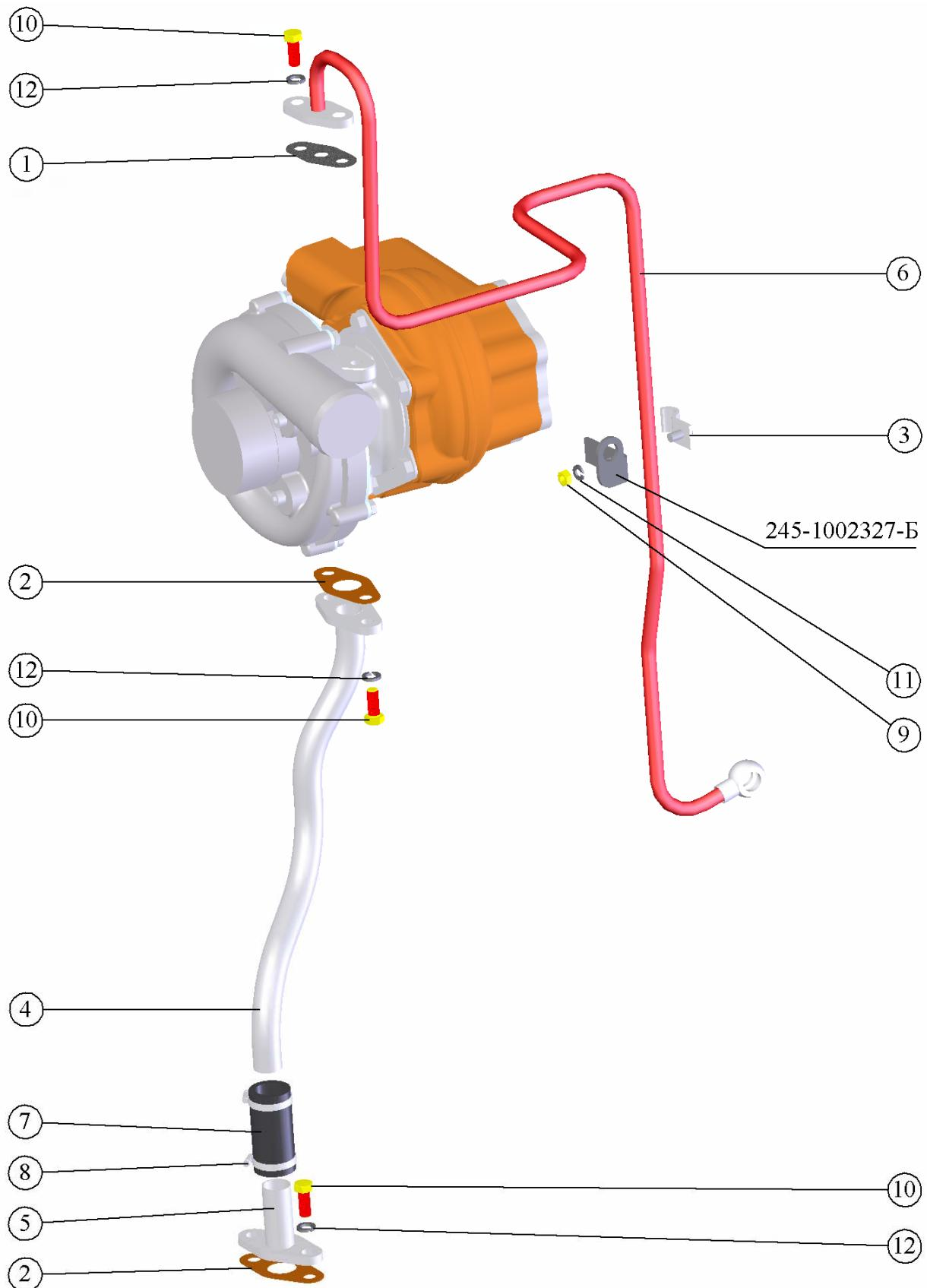
Рис. 19 Маслопроводы турбокомпрессора.
