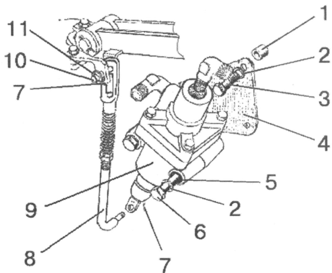
Рис. 35.10. Кран тормозной
