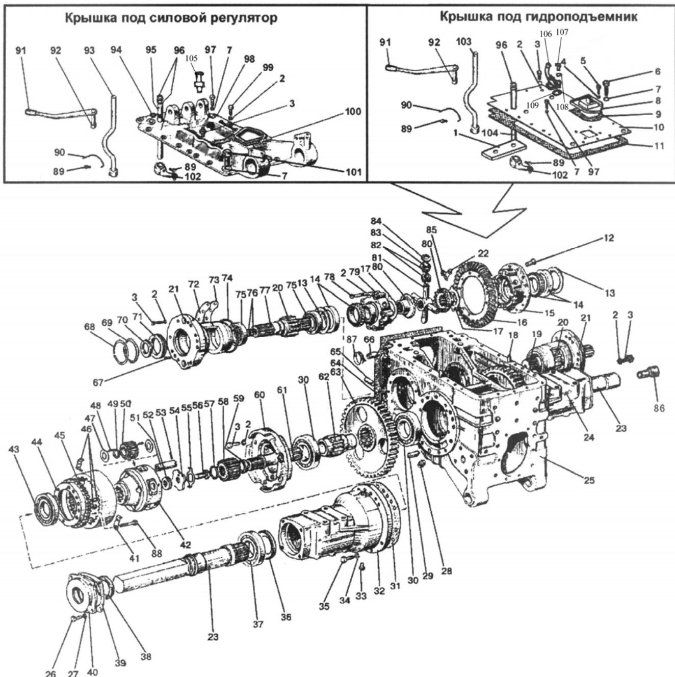
Рис. 24.1. Задний мост. Дифференциал. Конечные передачи
