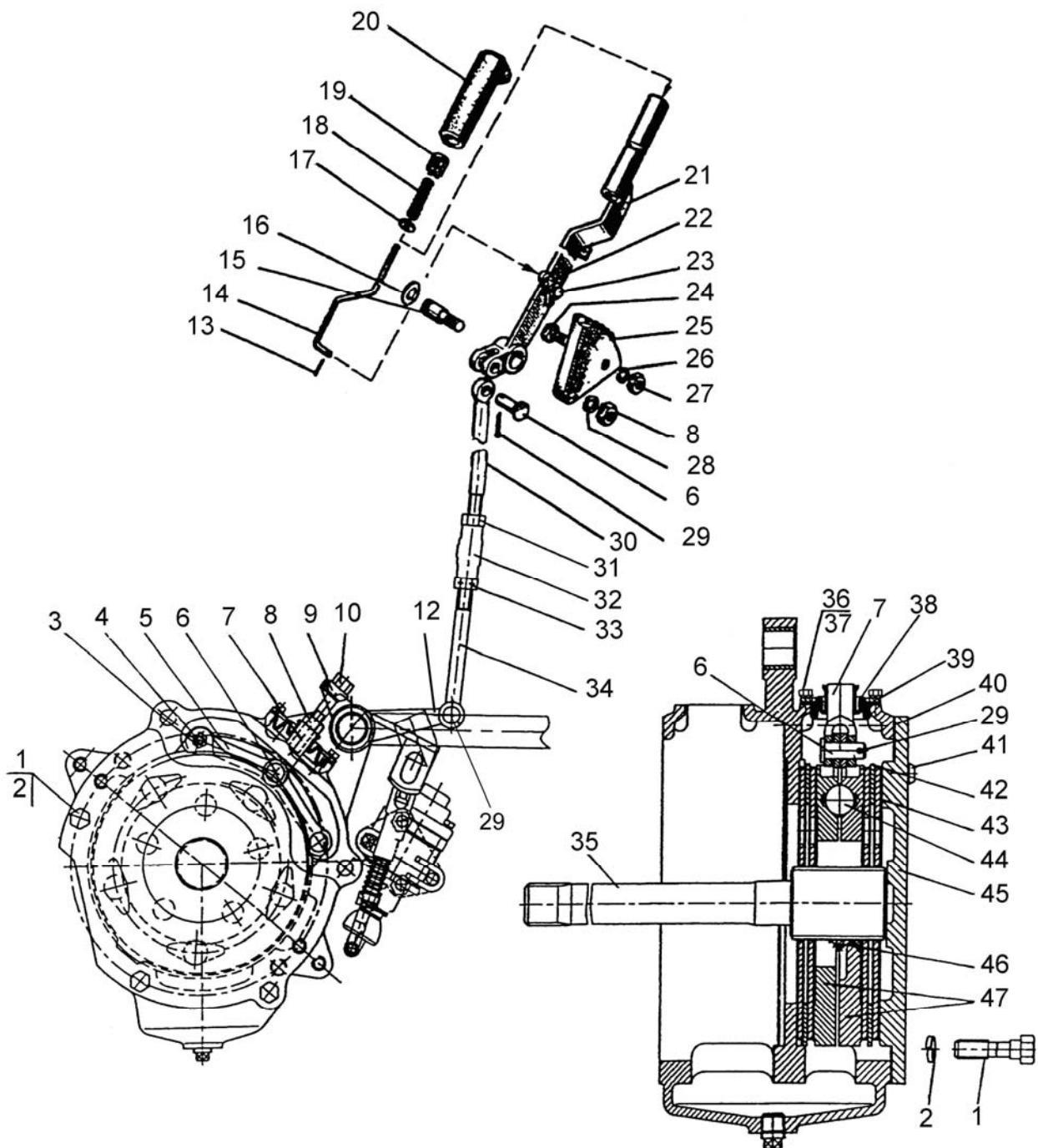
Рис. 35.6. Тормоз стояночно-запасной. Управление стояночно-запасным тормозом (для «мокрых тормозов»)
