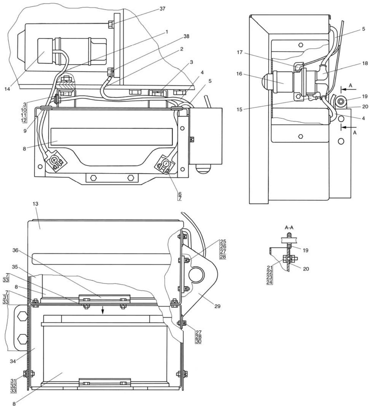
Рис. 37.6. Установка аккумуляторных батарей («БЕЛАРУС-1221В/1221В.2»)
