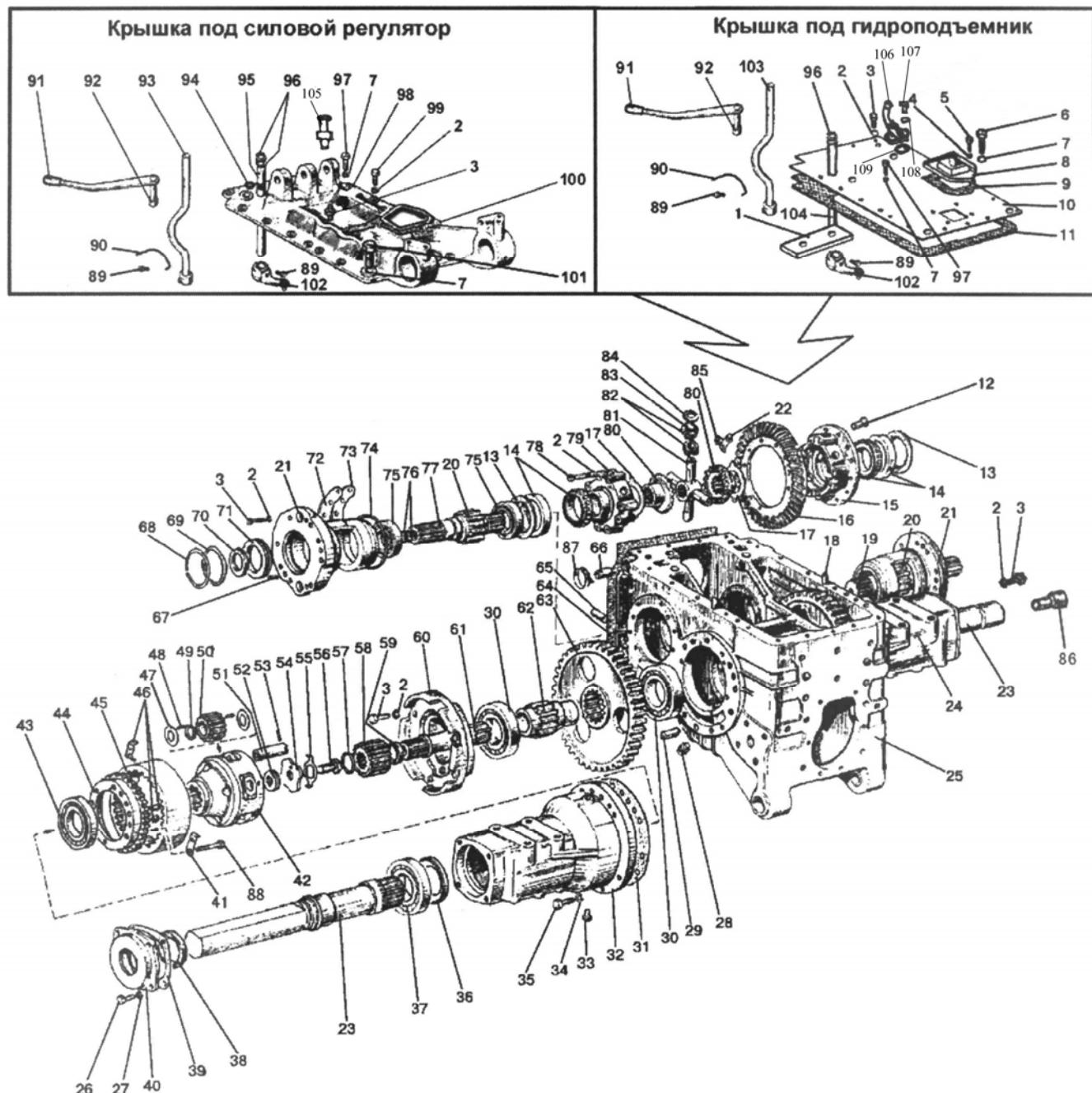
Рис. 24.1. Задний мост. Дифференциал. Конечные передачи
