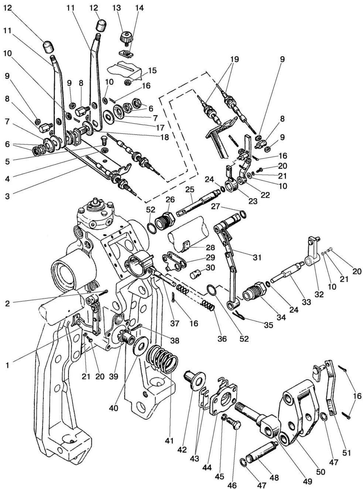
Рис. 46.15. Гидроподъемник. Управление гидроподъемником
