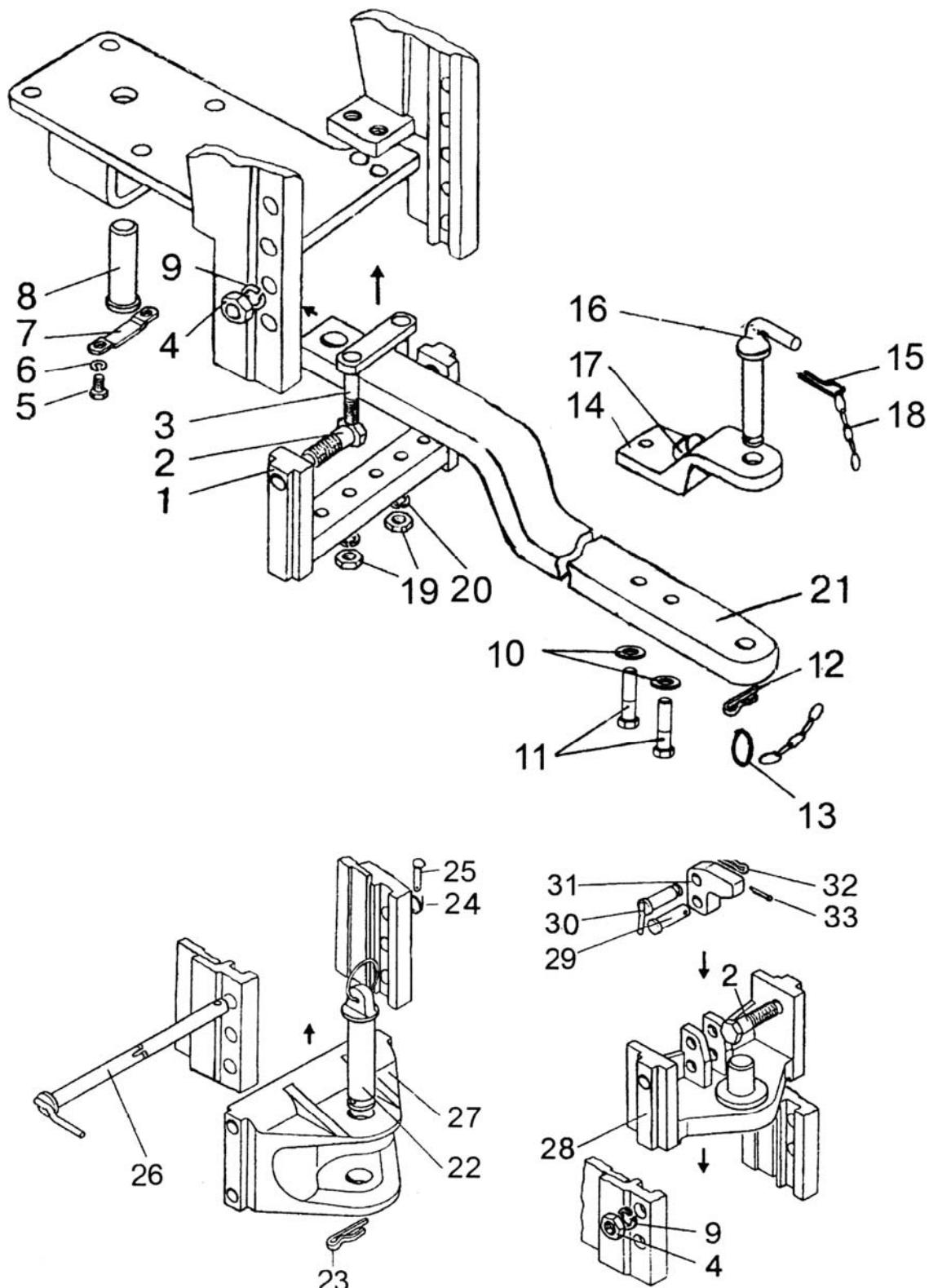
Рис. 27.3. Тягово-сцепное устройство (варианты комплектации)
