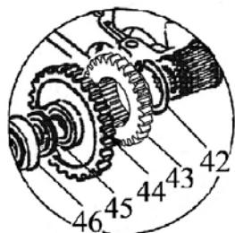
Рис. 17.10 Вал пониженных передач и заднего хода
