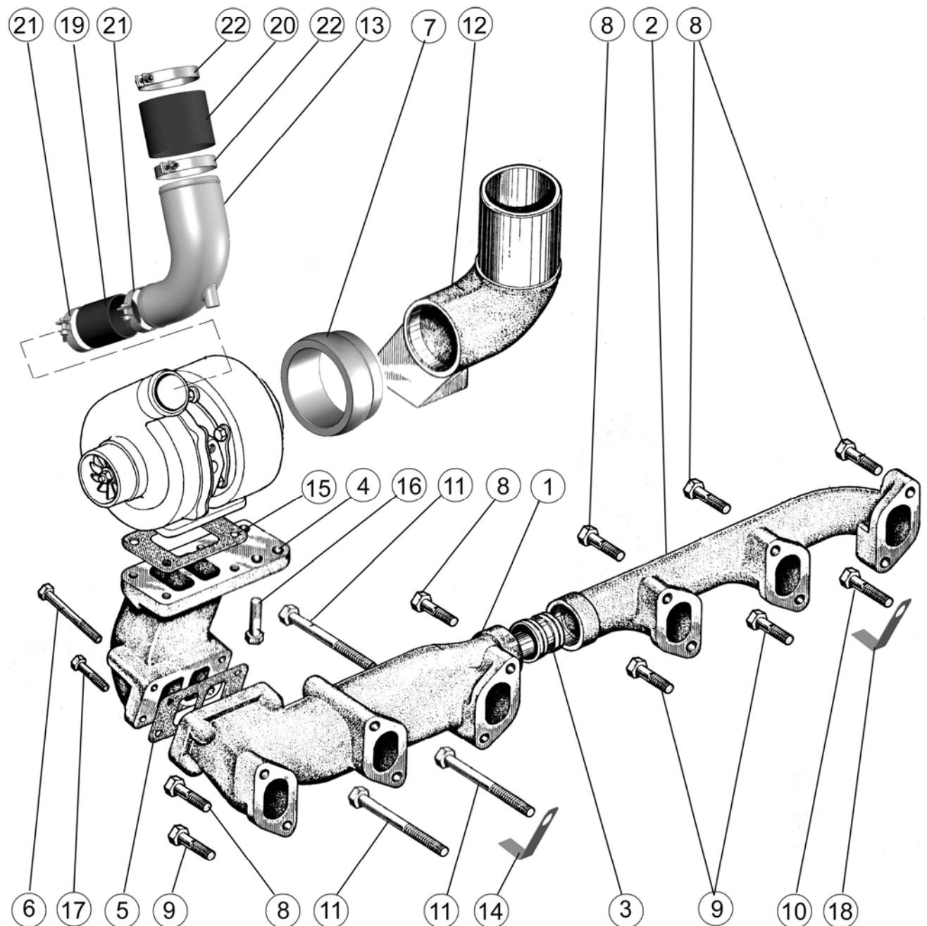
Рисунок 6. Установка турбокомпрессора
