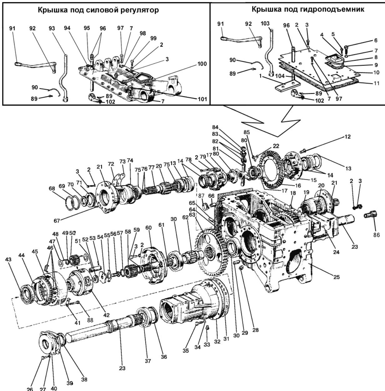
Рис. 24.1. Задний мост. Дифференциал. Конечные передачи (мокрые тормоза)
