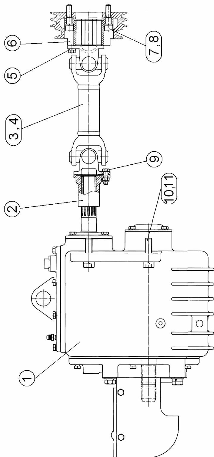
Рис. 42.2. Вал отбора мощности передний
