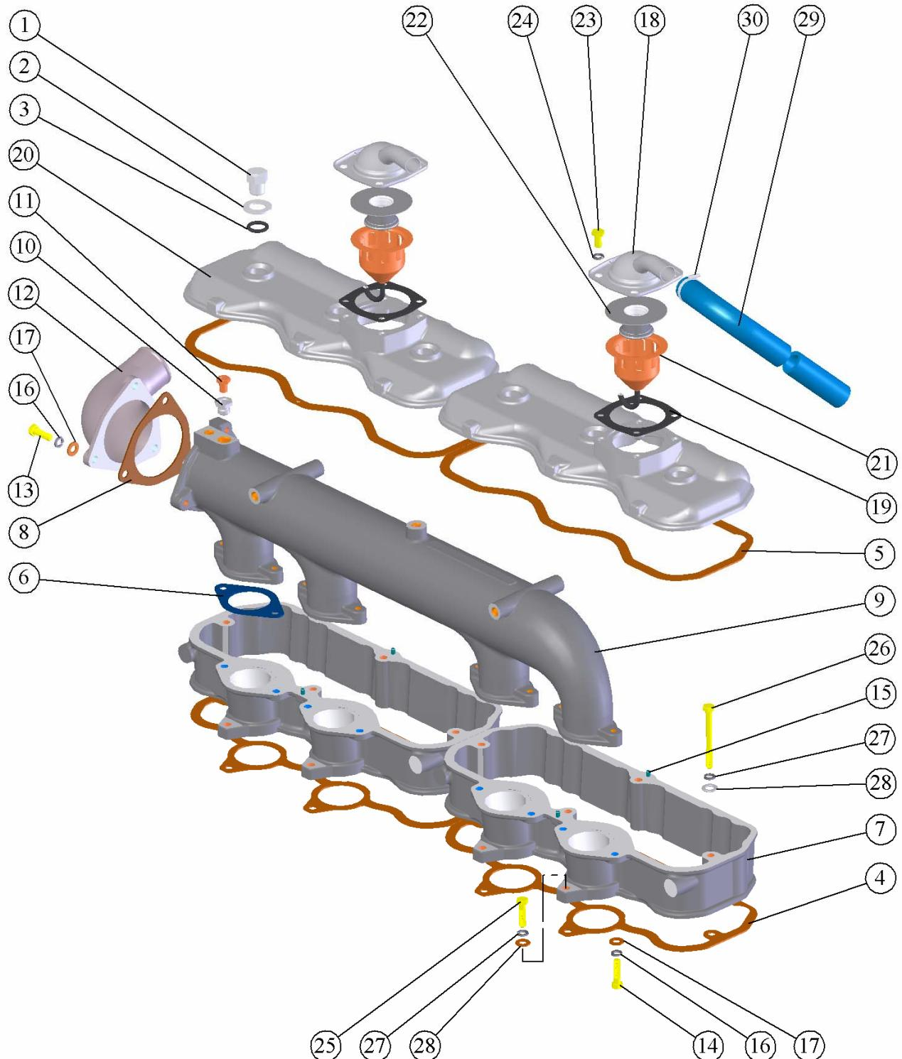
Рис. 3 Крышки головок цилиндров, коллектор и сапуны.
