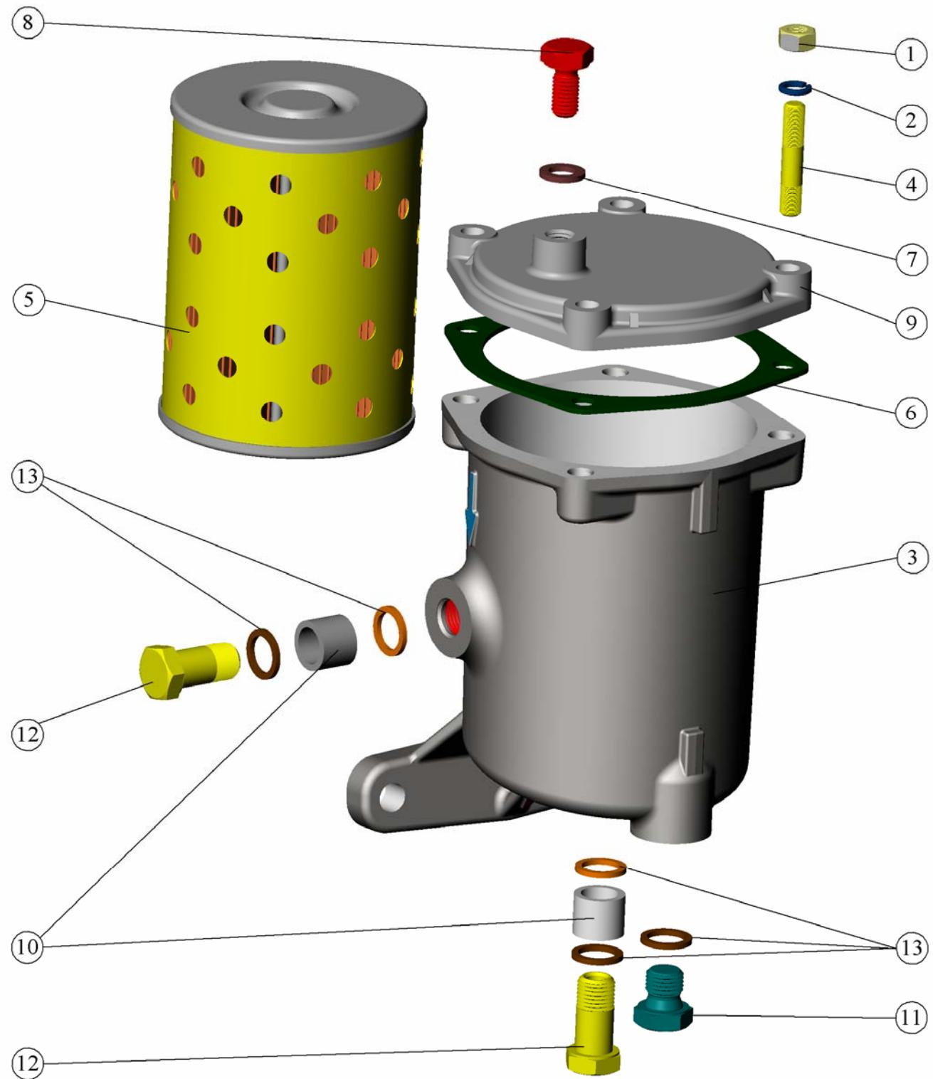
Рис. 11 Фильтр топливный тонкой очистки.
