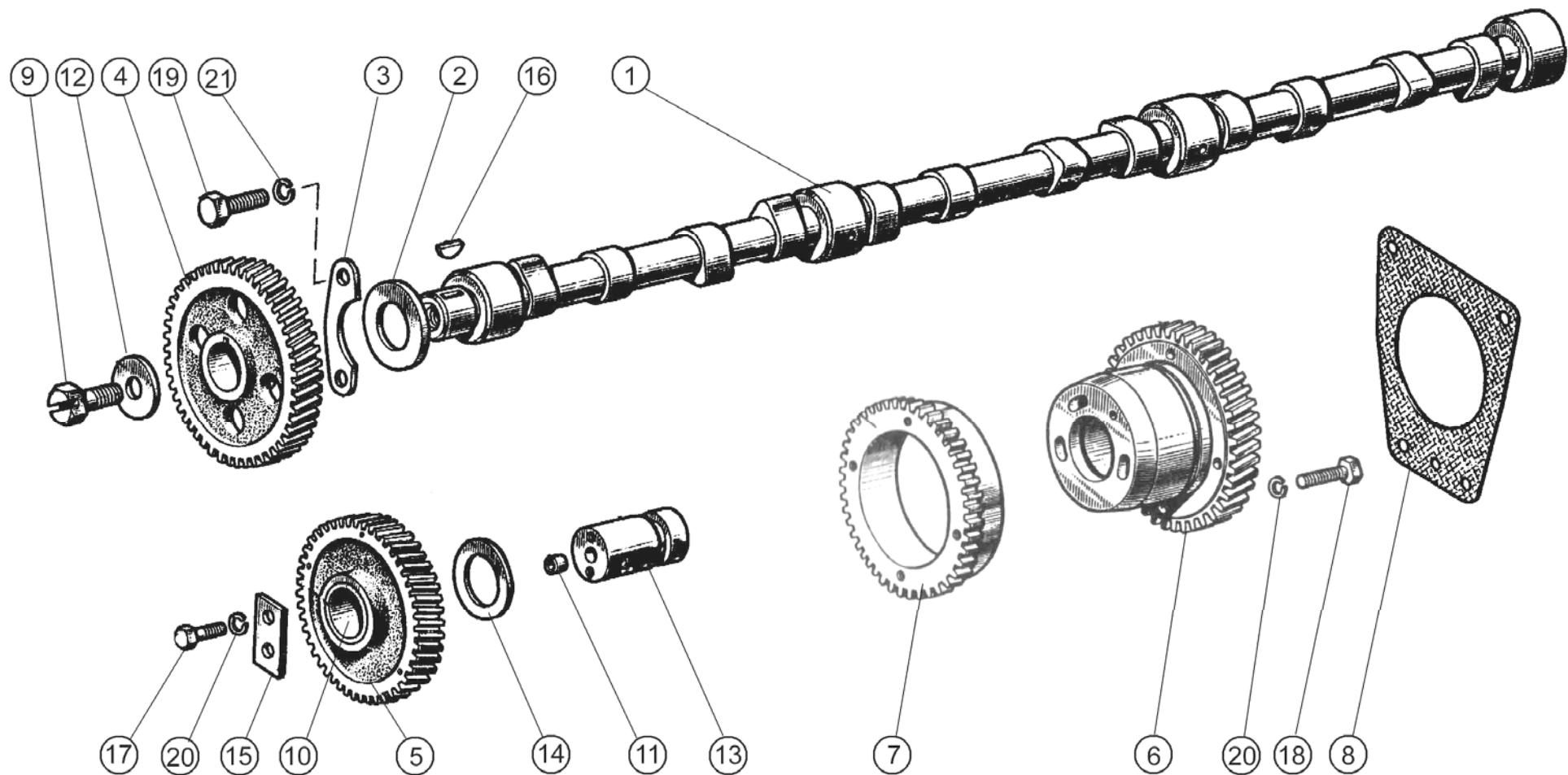
Рисунок 5. Распределительный механизм.
