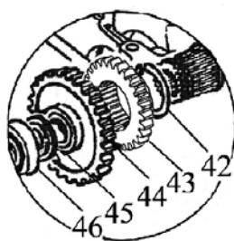
Рис. 17.10 Вал пониженных передач и заднего хода
