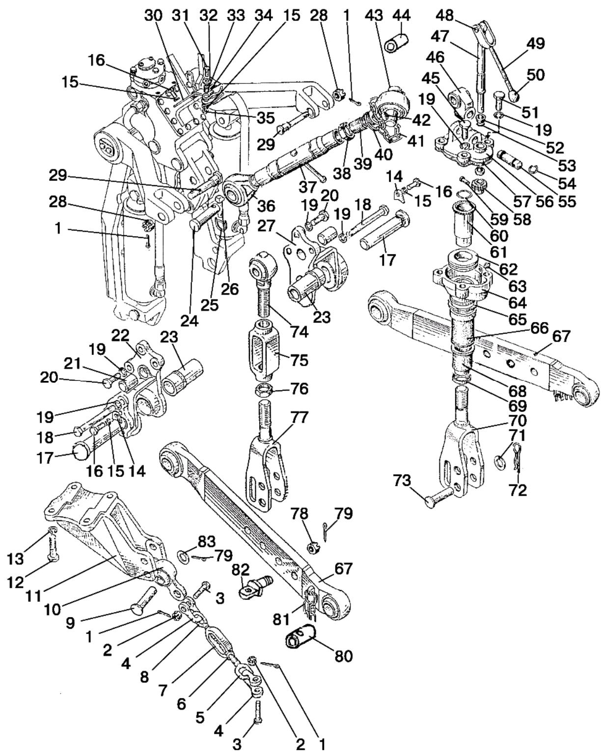
Рис. 46.2. Навесное устройство с гидроподъемником
