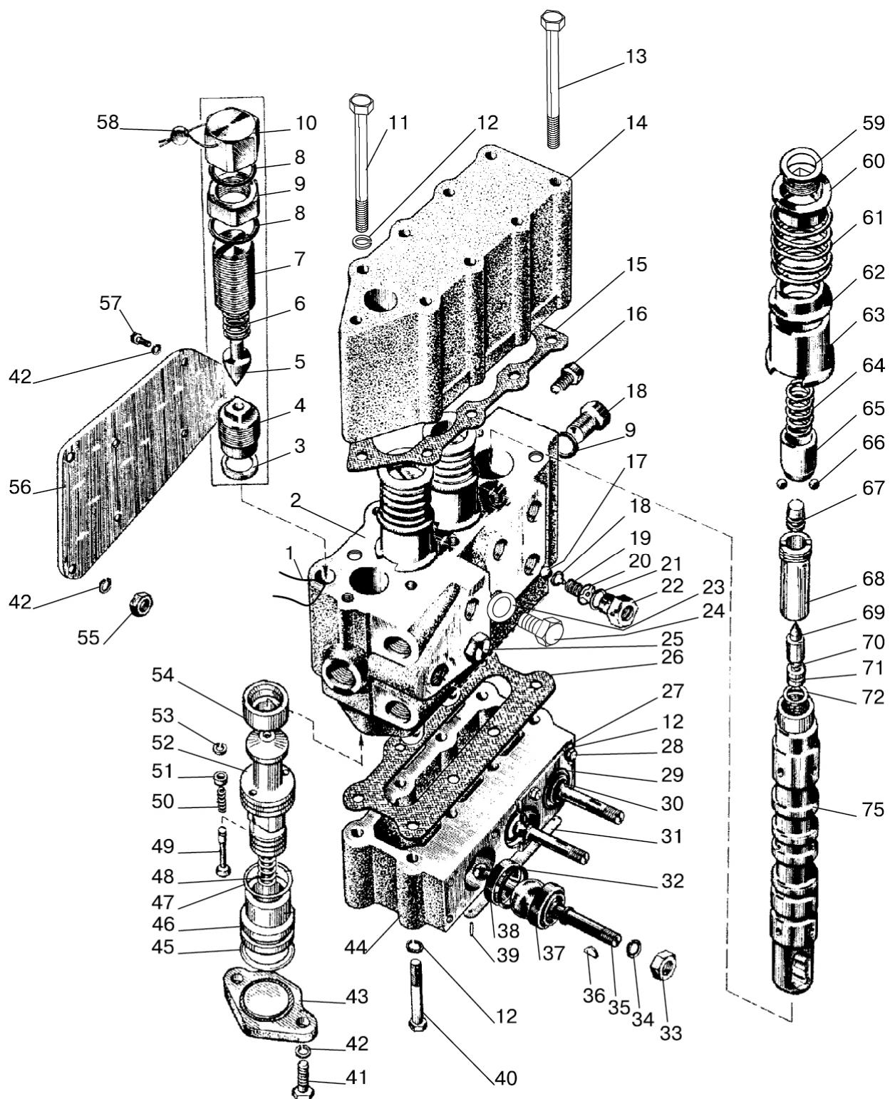
Рис. 46.9. Гидрораспределитель Р80
