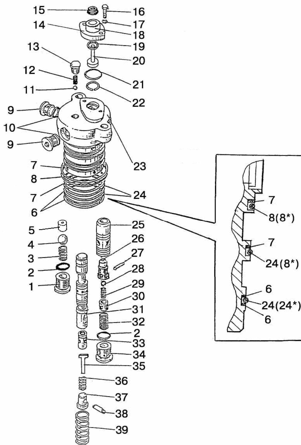
Рис. 46.14. Распределитель гидроподъемника
