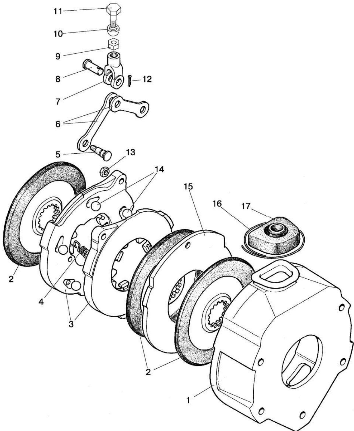
Рис. 35.2. Тормоза (вариант исполнения)
