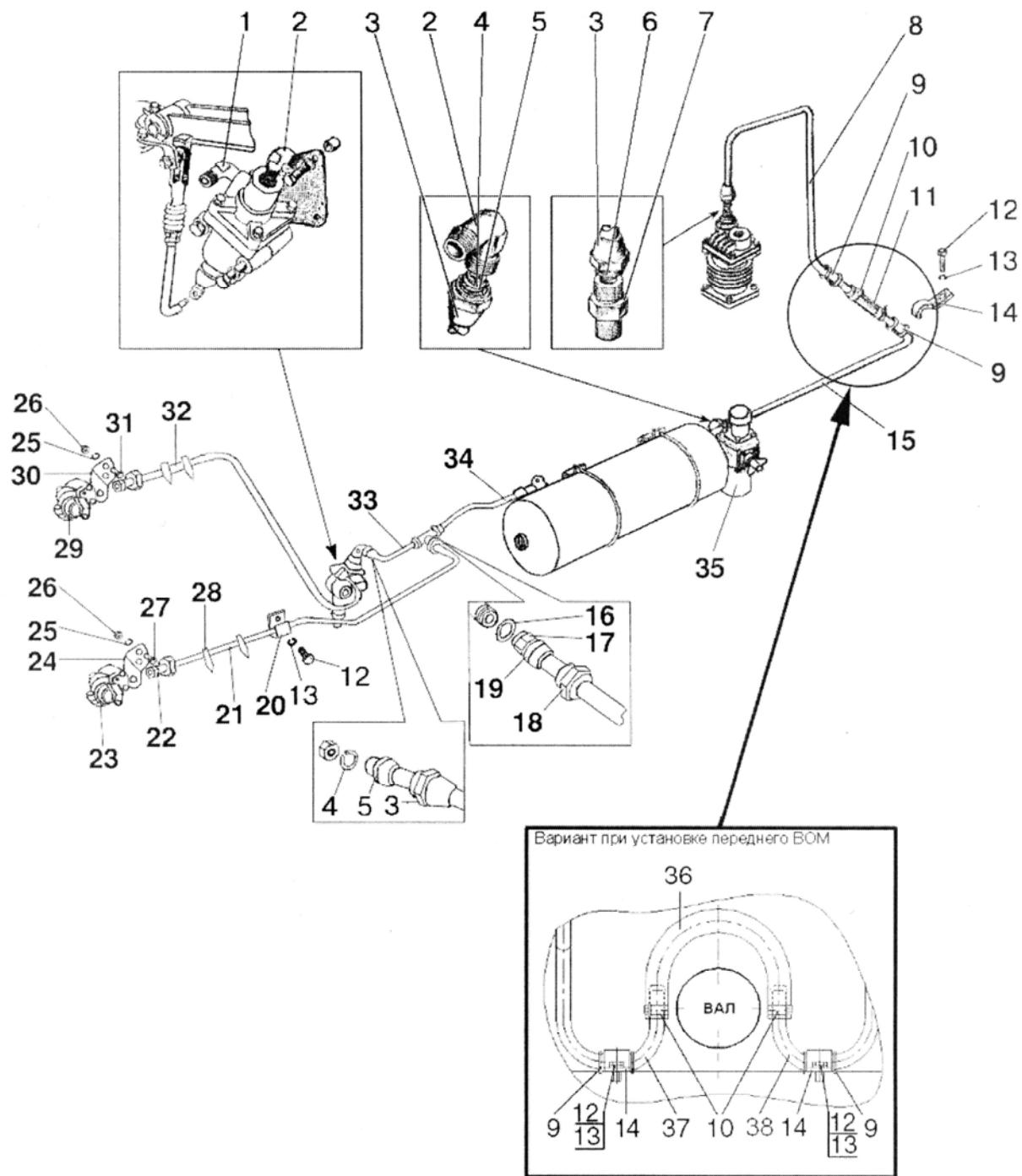
Рис. 35.8. Трубопроводы и арматура двухпроводного пневмопривода тормозов прицепа
