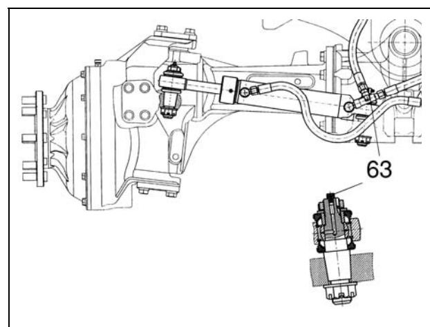
Рис. 34.3. Управление рулевое гидрообъемное
