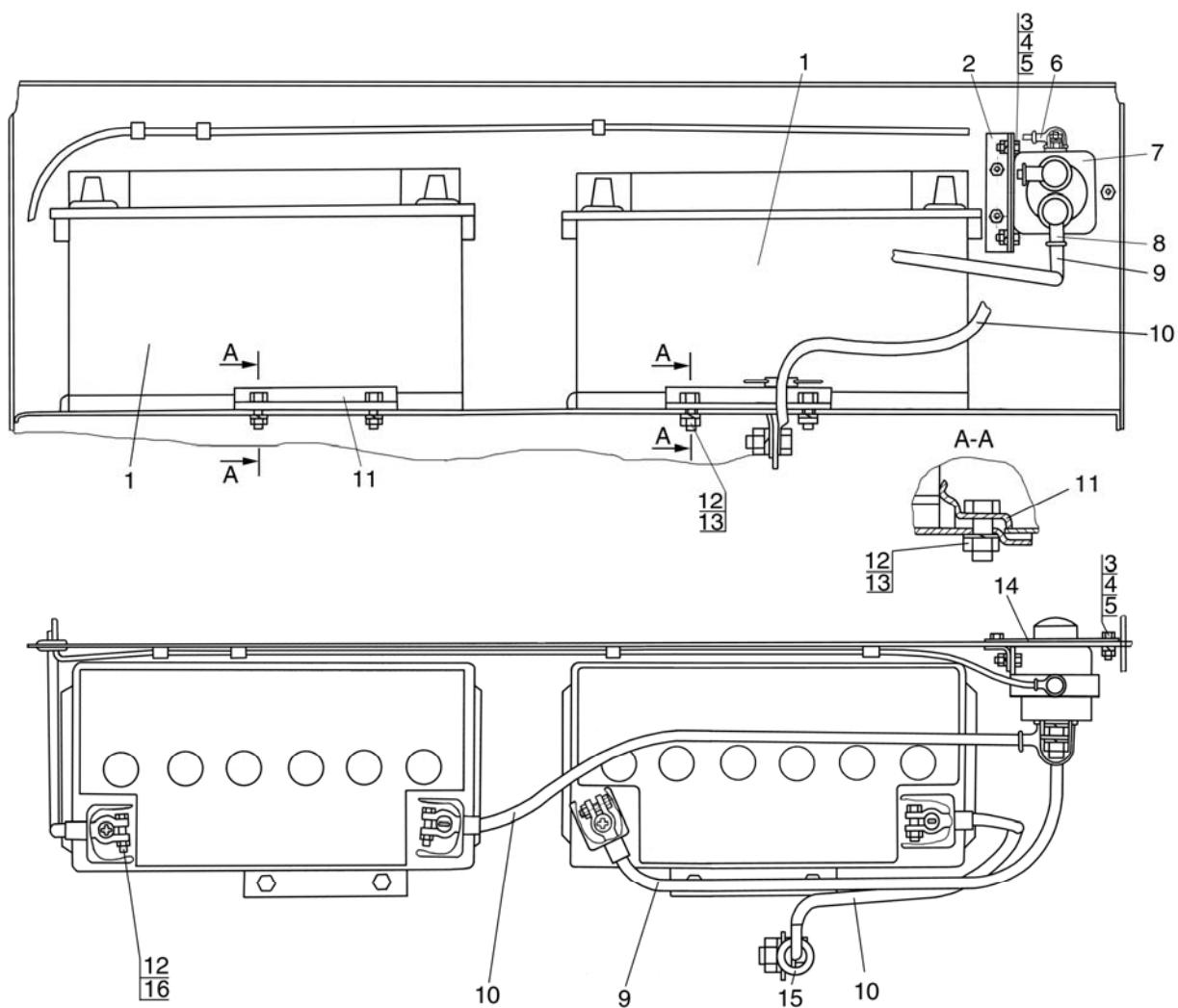
Рис. 37.5. Установка аккумуляторных батарей («БЕЛАРУС-1221/1221.2/1221.3»)
