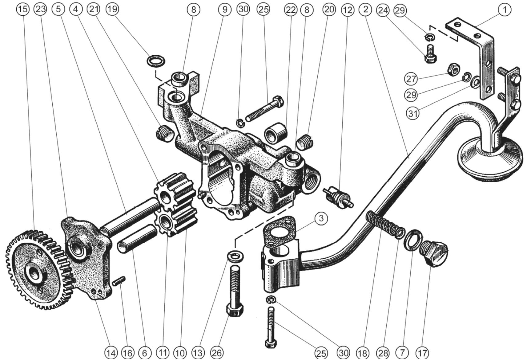
Рисунок 8. Приемник масляного насоса и масляный насос.
