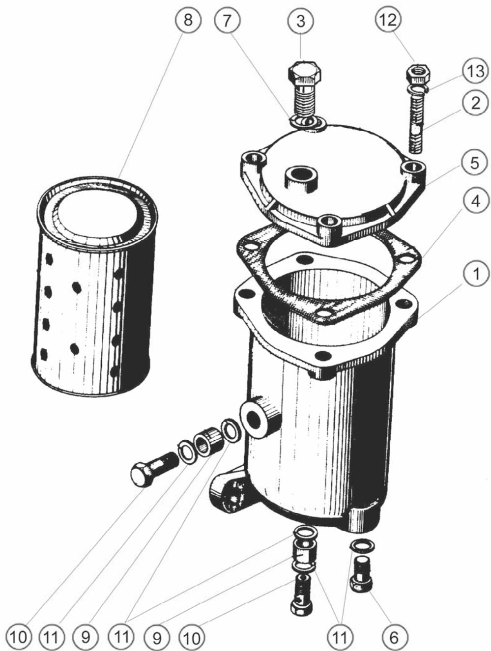
Рисунок 16. Фильтр топливный тонкой очистки
