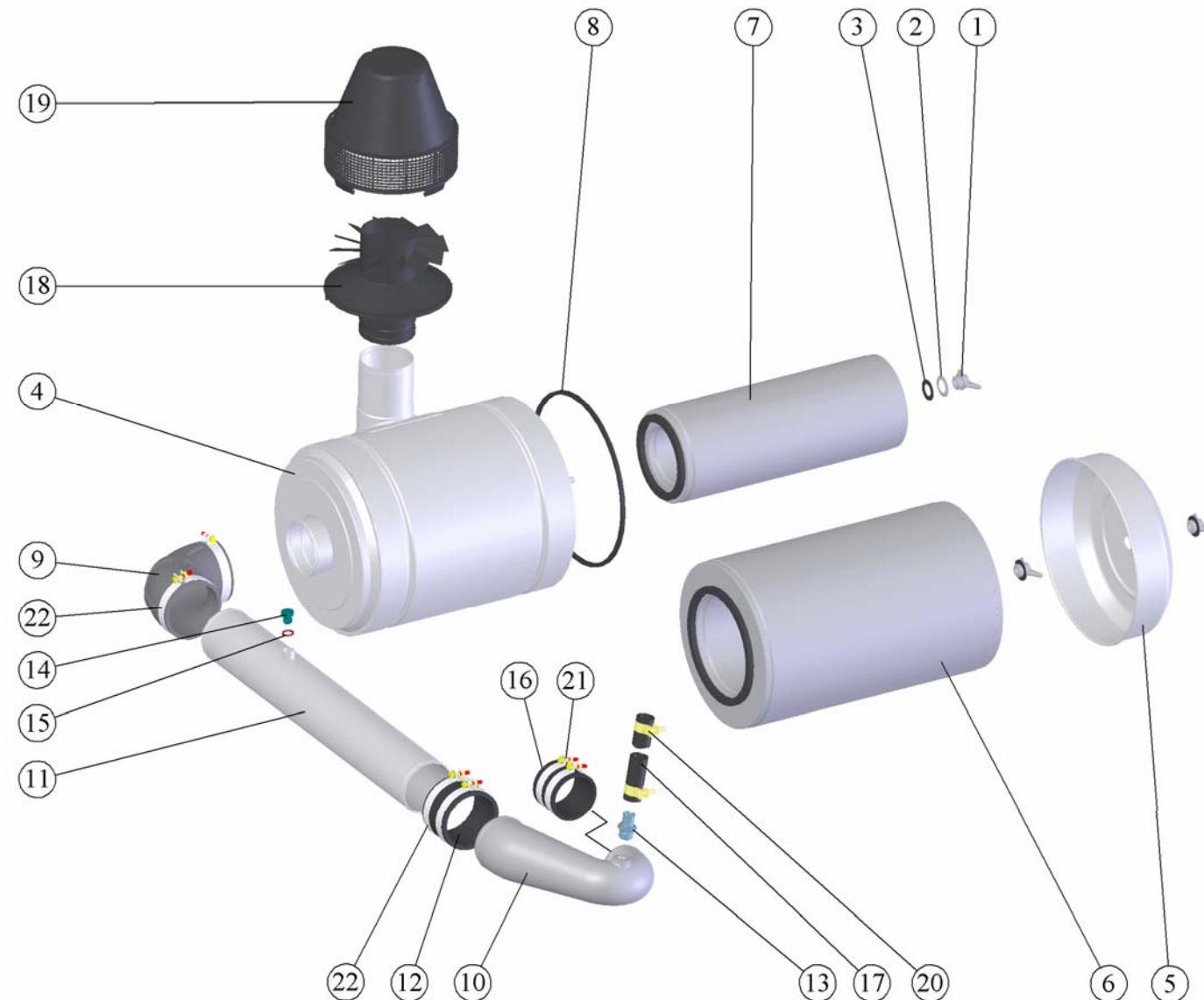
Рис. 9 Воздухоподводящий тракт.
