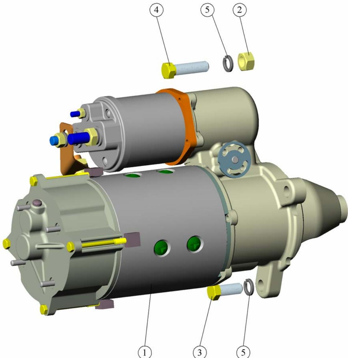
Рис. 24 Установка стартера.
