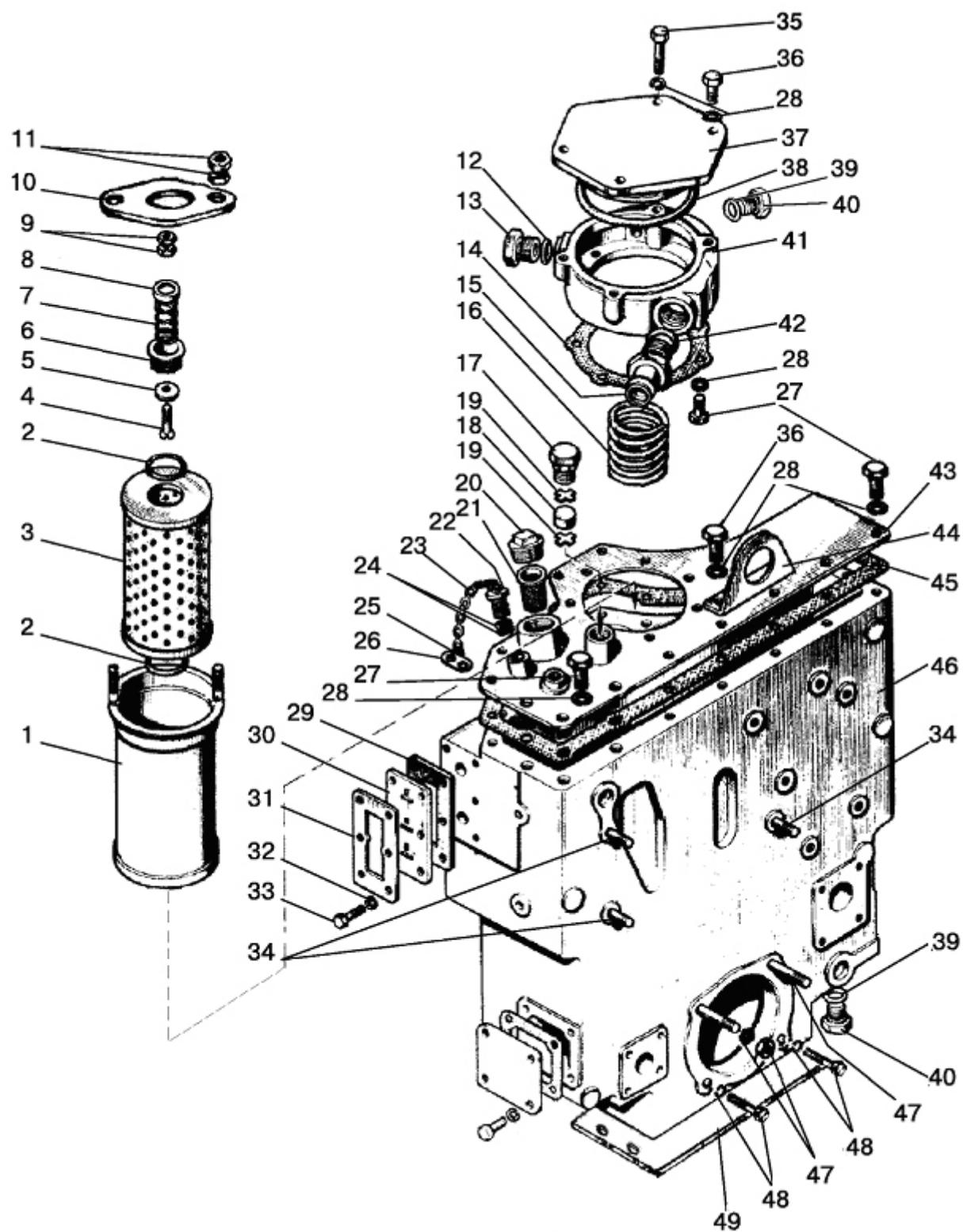
Рис. 46.11. Корпус гидросистемы и фильтр
