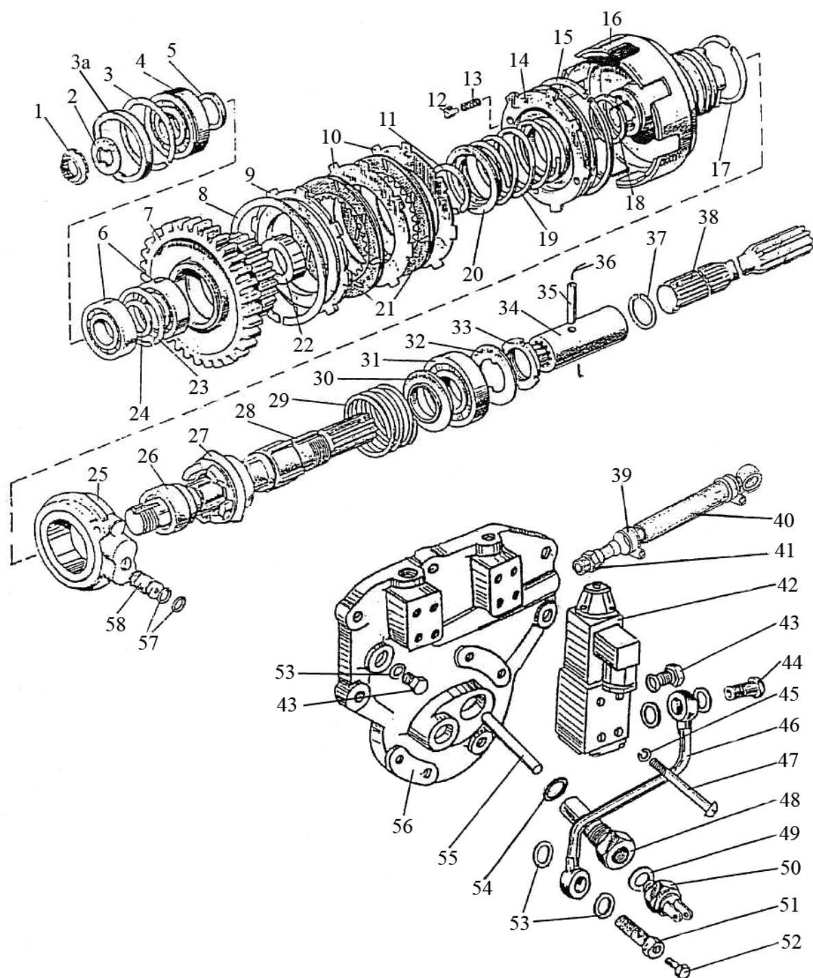
Рис. 18.1. Привод переднего ведущего моста
