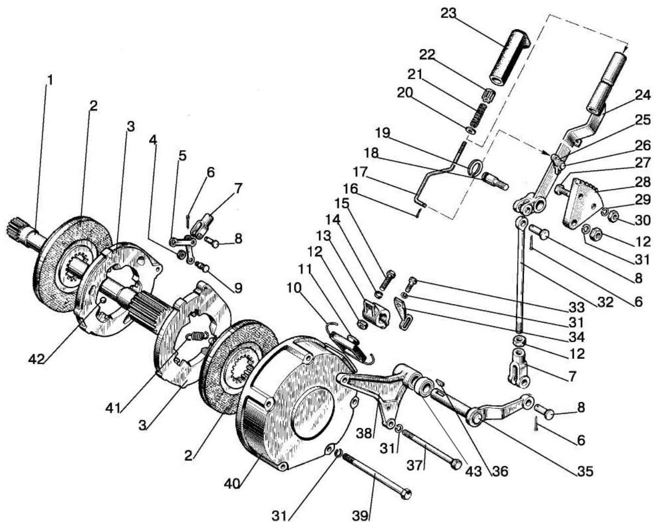
Рис. 35.5. Тормоз стояночно-запасной, управление стояночно-запасным тормозом
