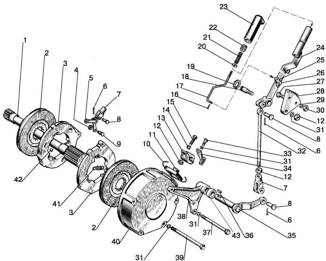
Рис. 35.5. Тормоз стояночно-запасной, управление стояночно-запасным тормозом
