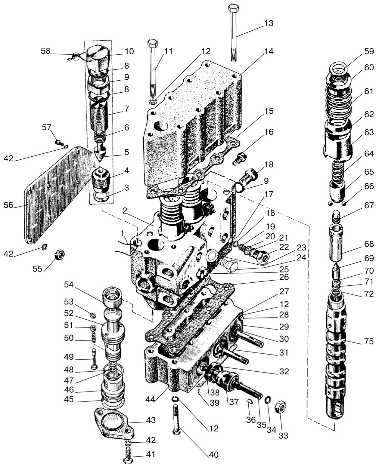
Рис. 46.9. Гидрораспределитель Р80
