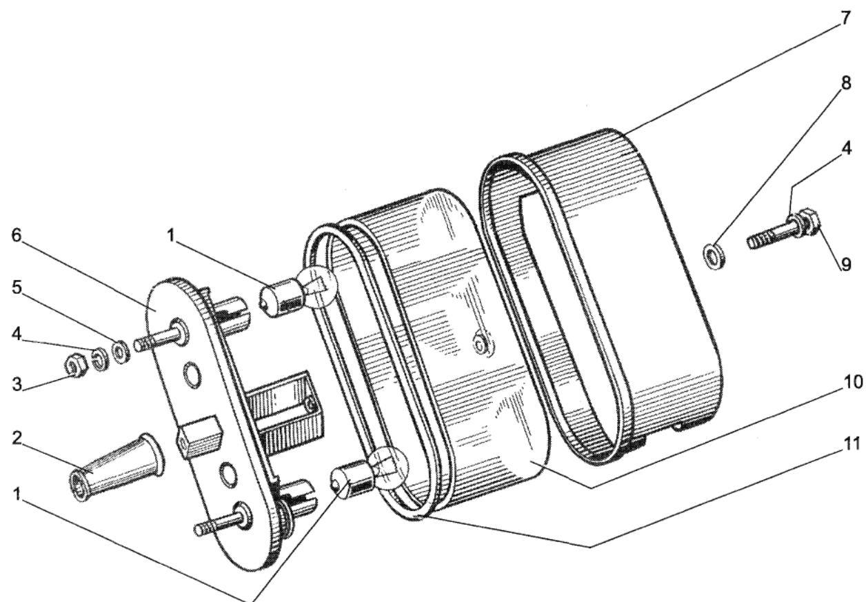
Рис. 37.11. Фонарь освещения номерного знака
