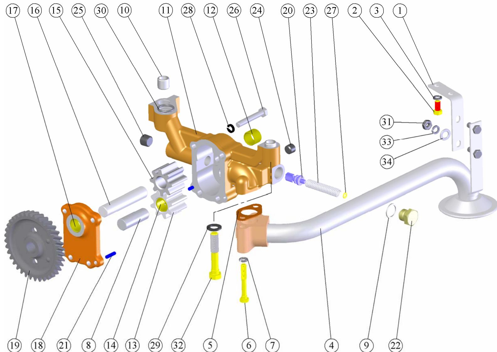
Рис. 15 Установка насоса масляного. Установка приёмника насоса масляного.
