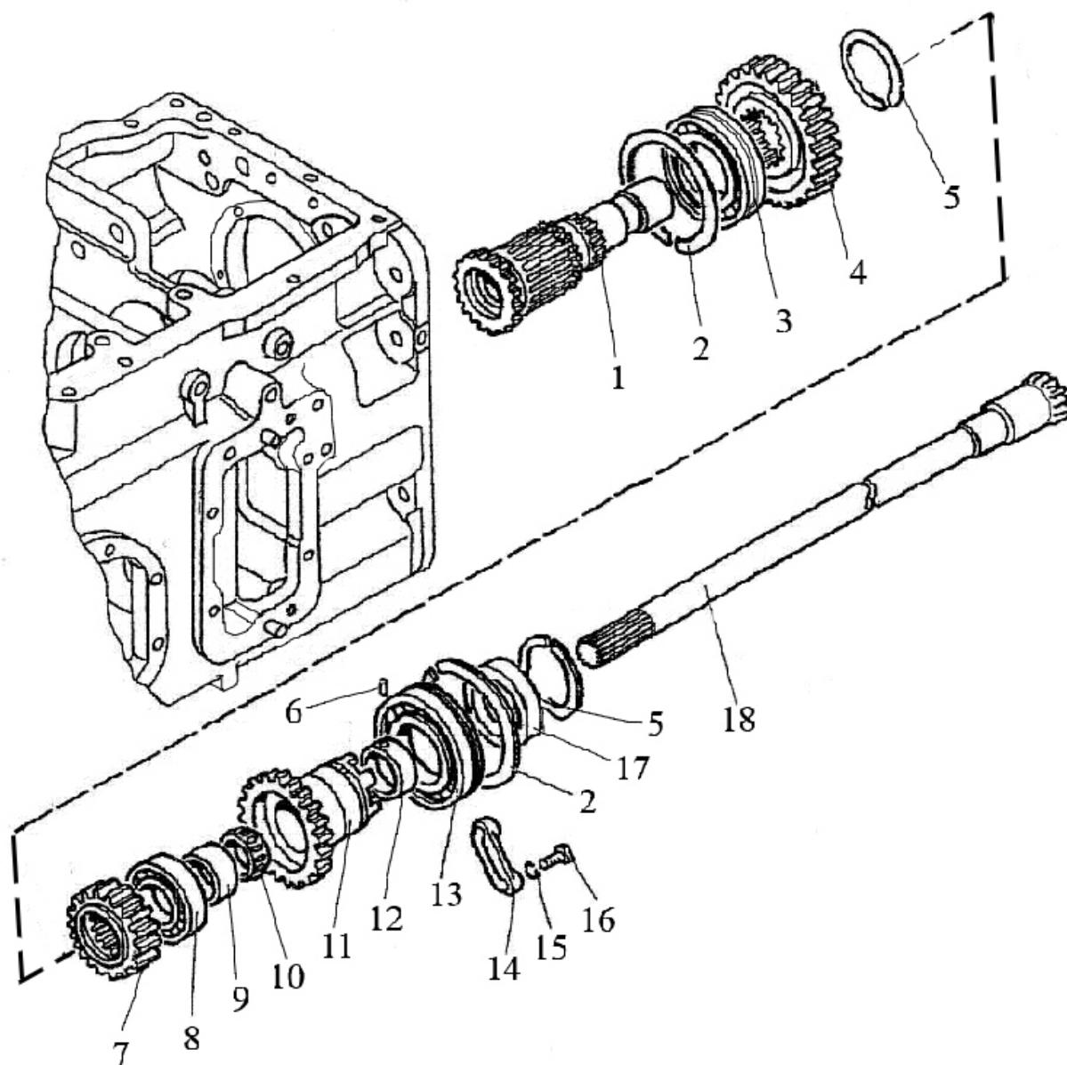
Рис. 17.11 Вал блока шестерен
