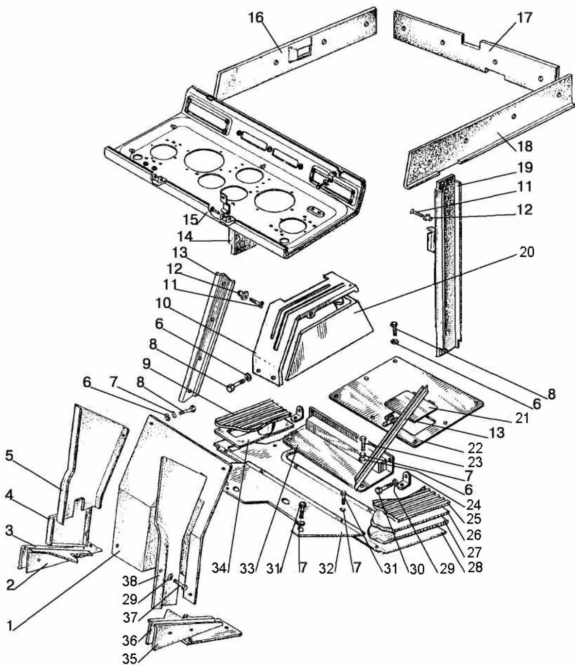
Рис. 67.2. Кабина трактора
