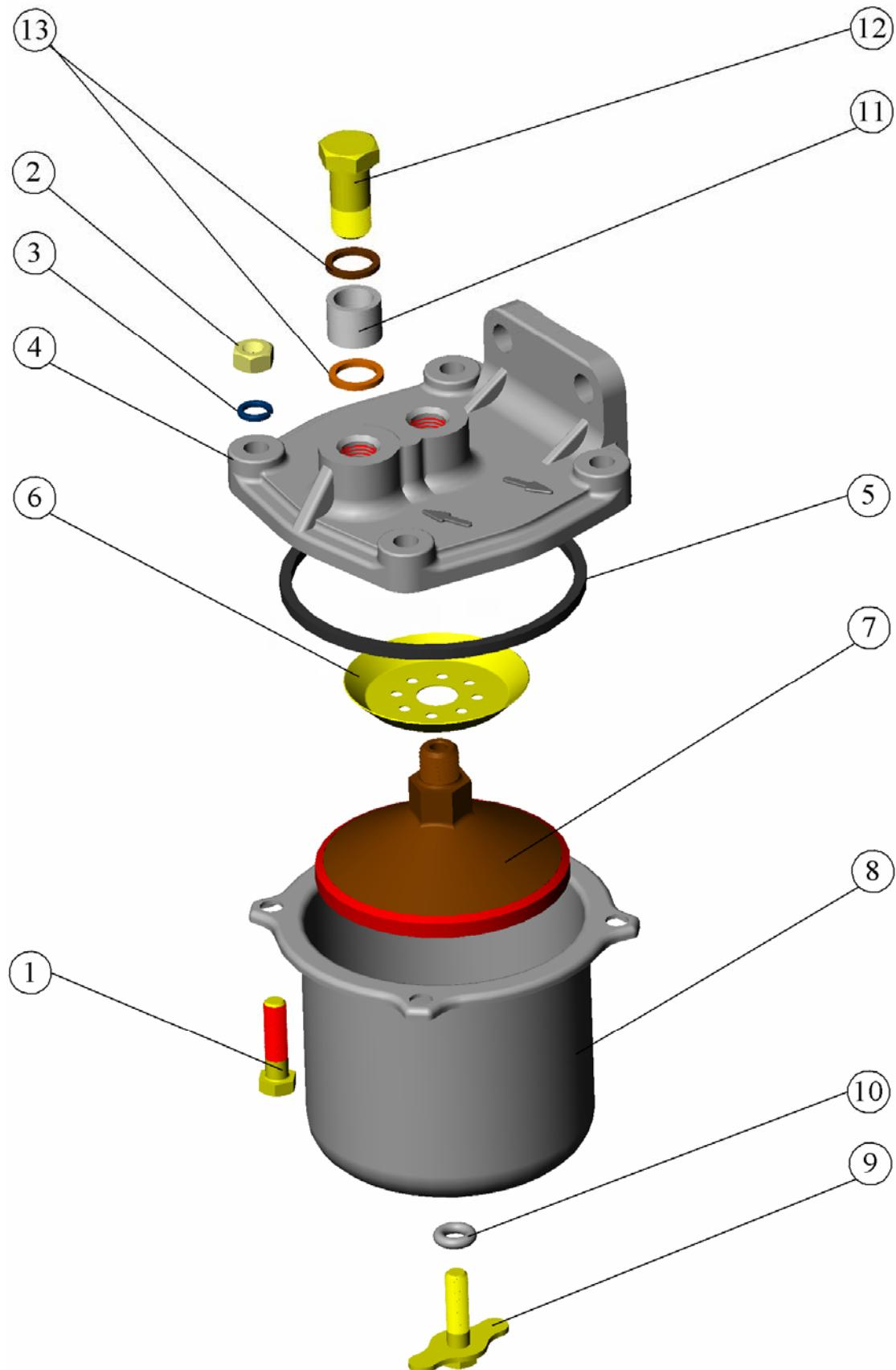
Рис. 10 Фильтр топливный грубой очистки.
