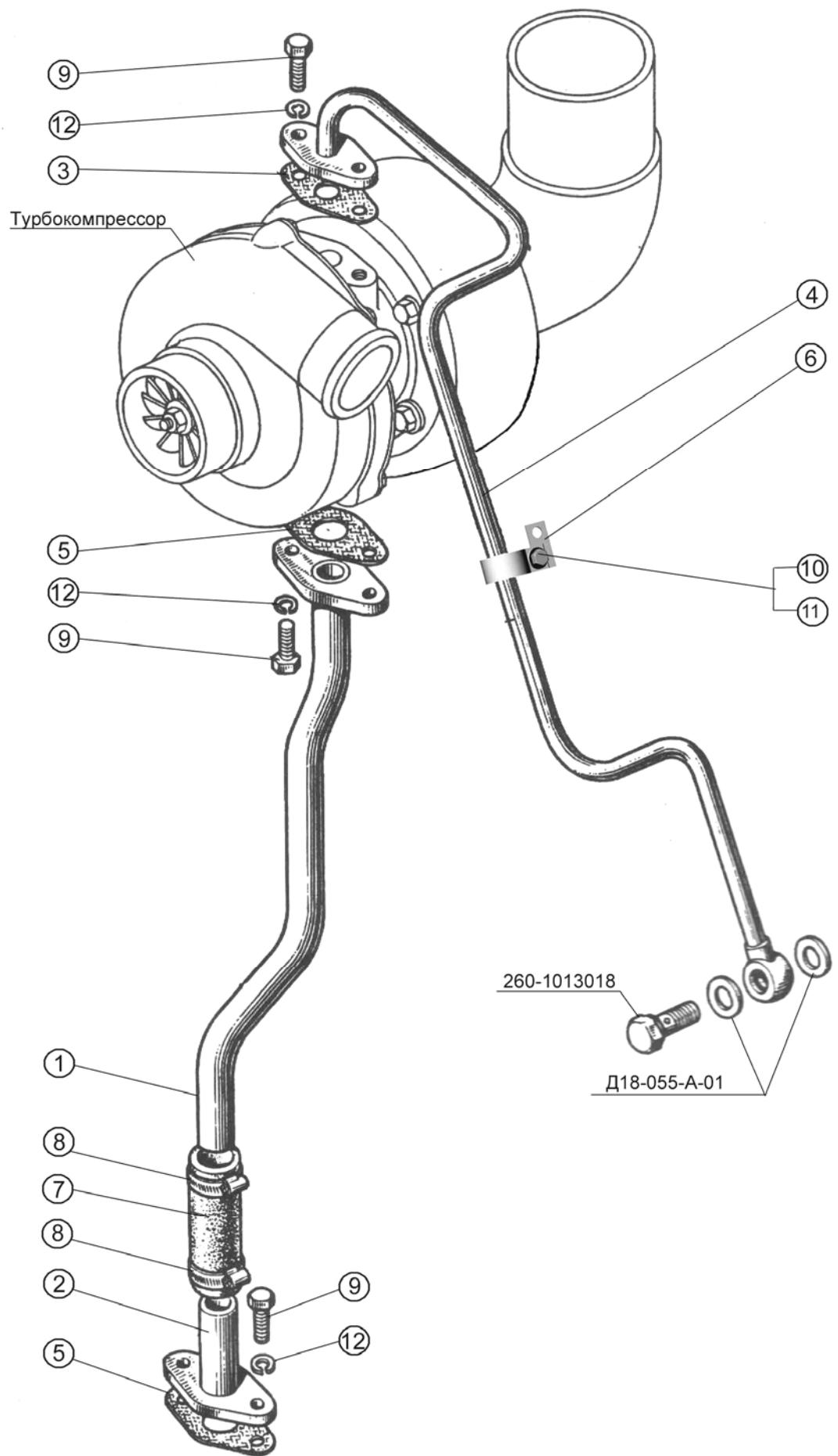
Рисунок12. Маслопроводы турбокомпрессора.
