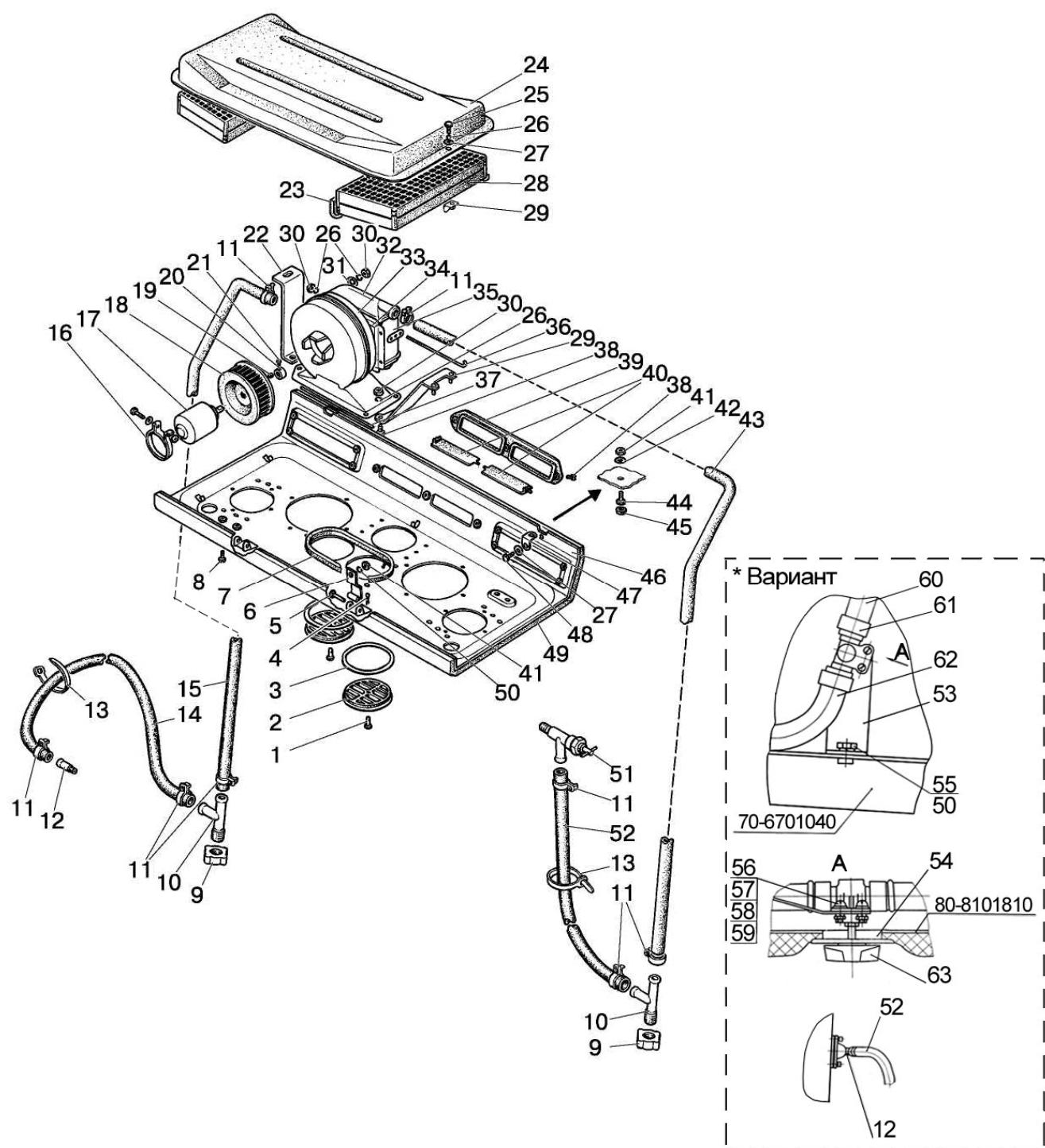
Рис. 81.1. Установка отопителя
