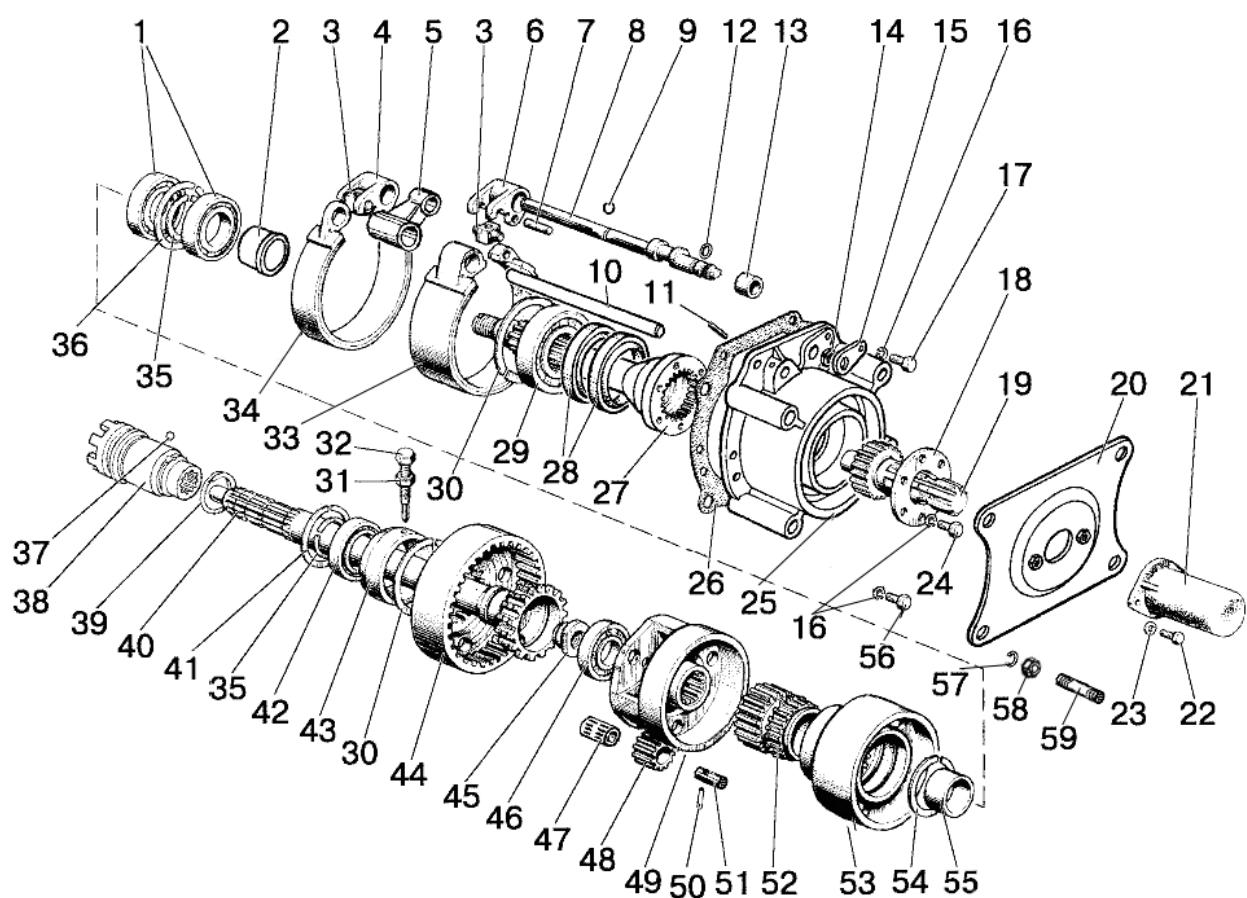
Рис. 42.1. Вал отбора мощности задний
