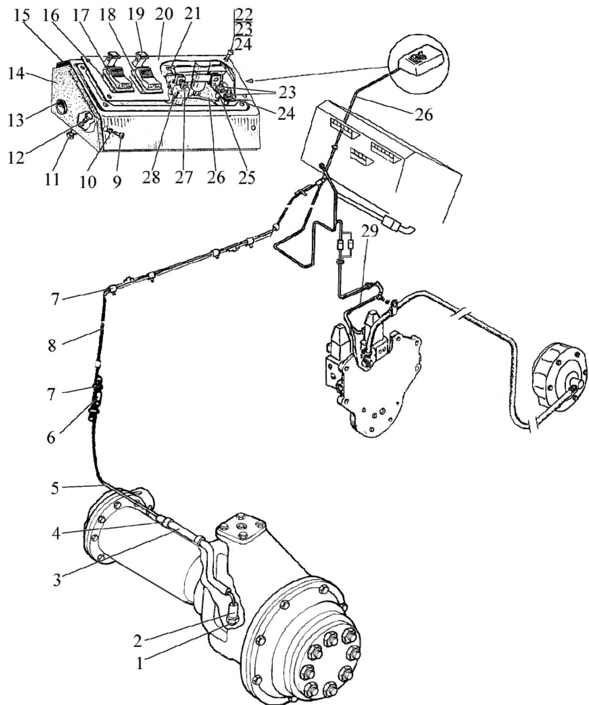
Рис. 87.1. Управление ПВМ и БД заднего моста (1221-8700410-Д)
