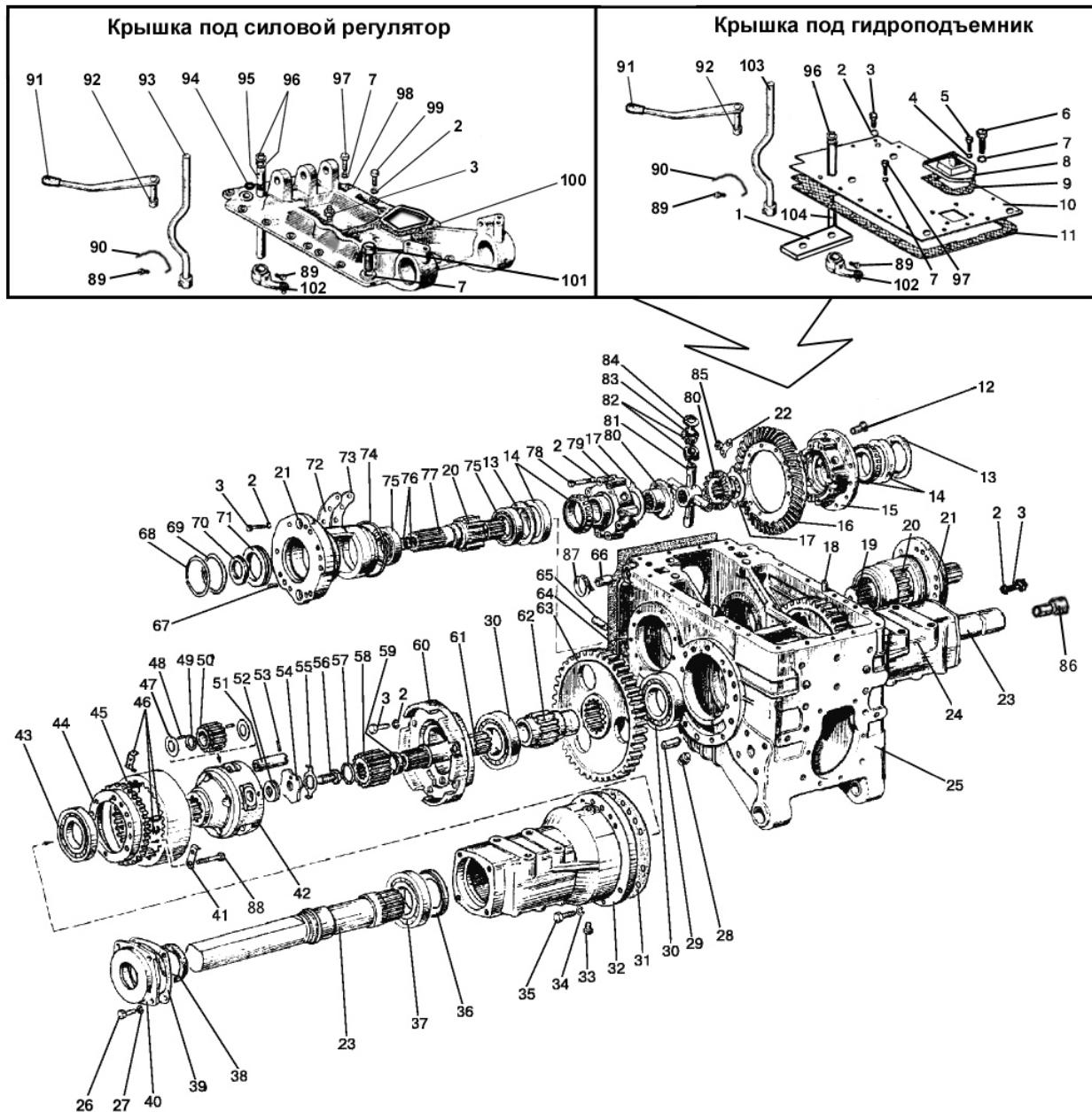
Рис. 24.1. Задний мост. Дифференциал. Конечные передачи
