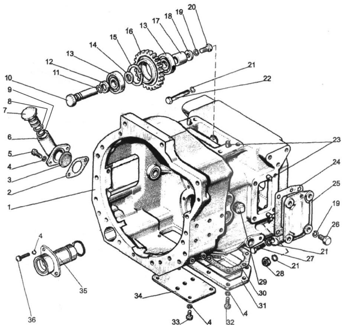
Рис. 16.2. Корпус сцепления
