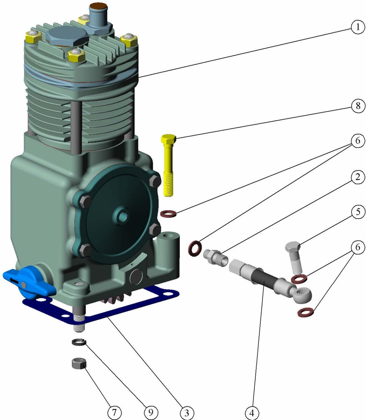
Рис. 22 Установка пневмокомпрессора.
