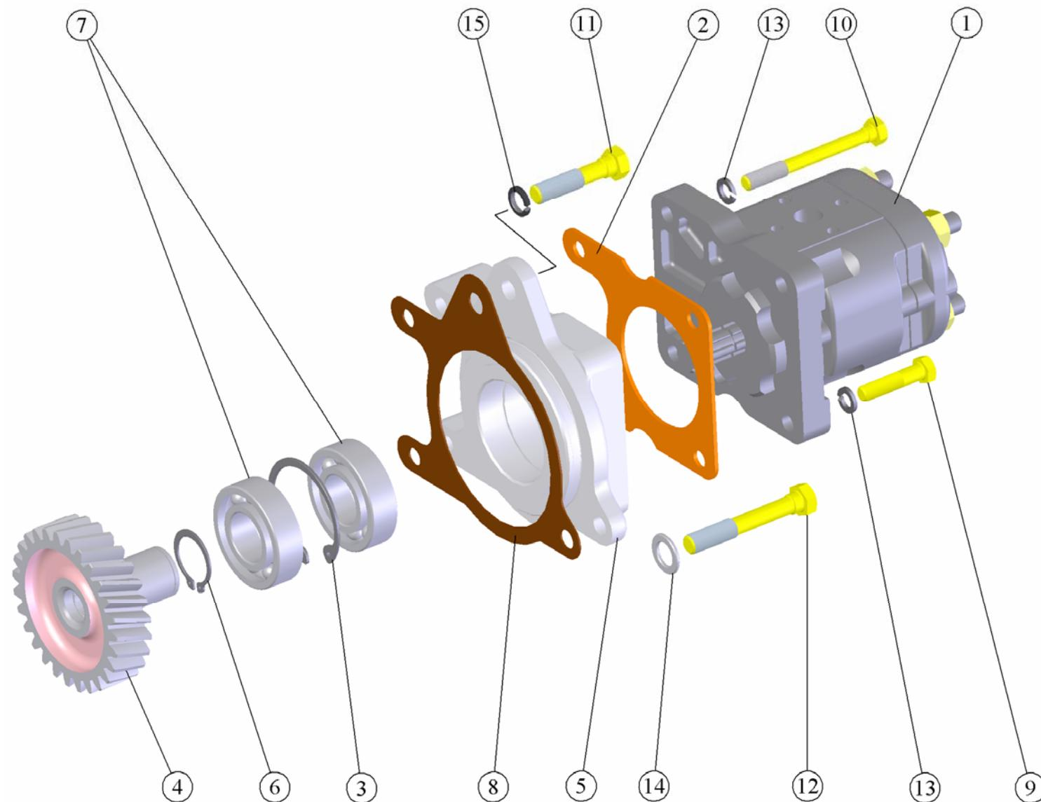
Рис. 21 Установка насоса рулевого управления.
