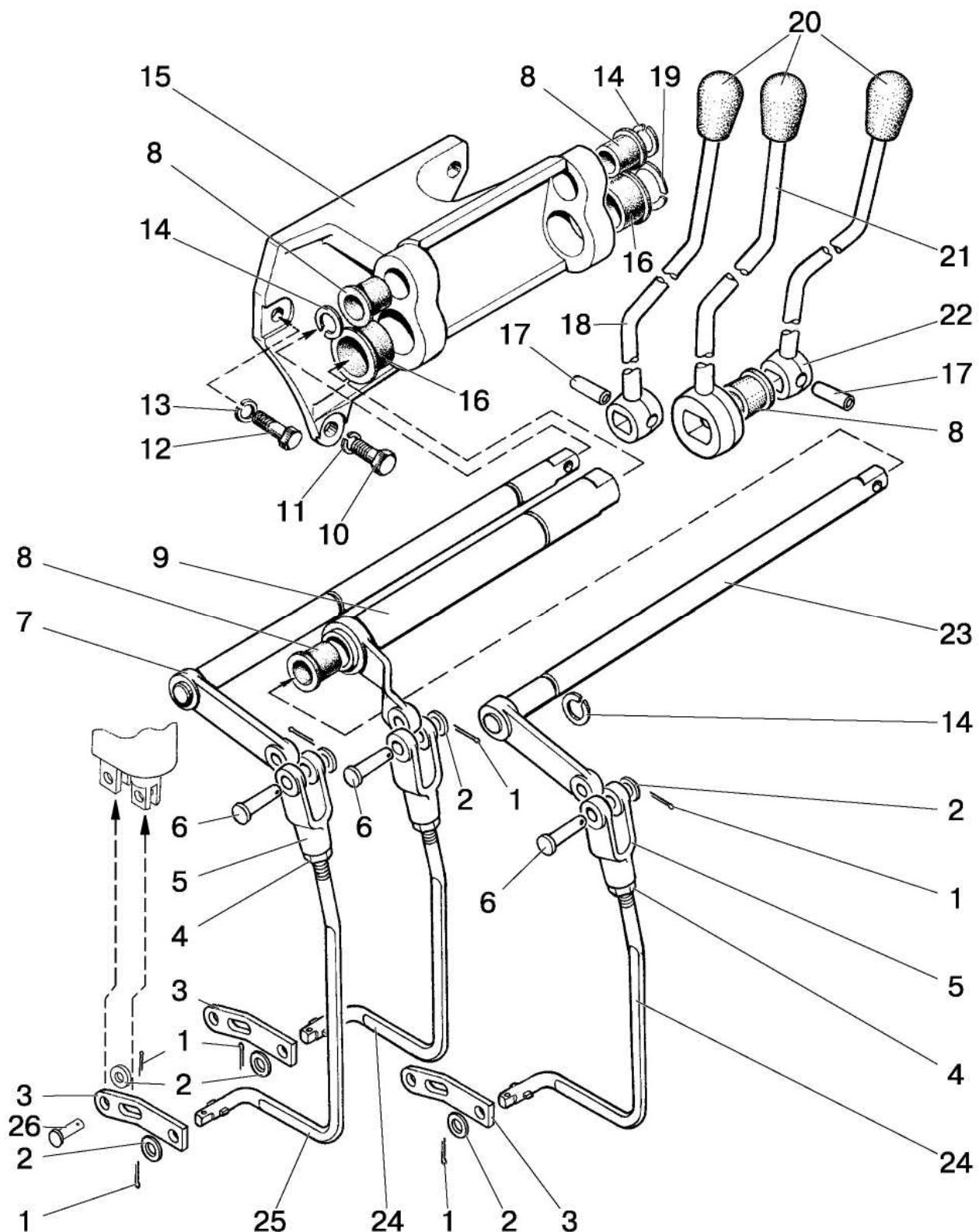
Рис. 46.10. Управление гидрораспределителем (РП70, Р80)
