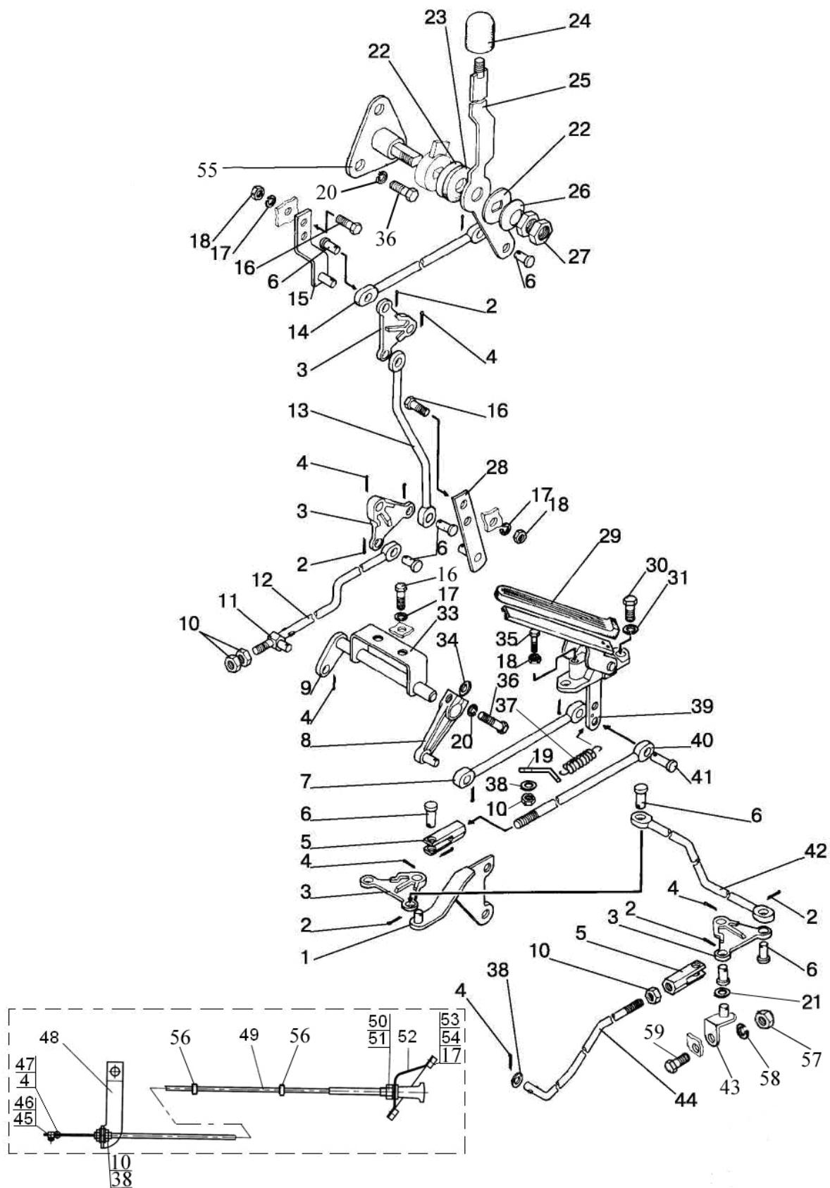
Рис.11.2. Управление подачей топлива
