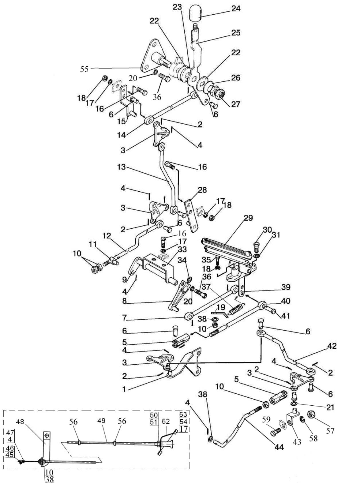
Рис.11.2. Управление подачей топлива
