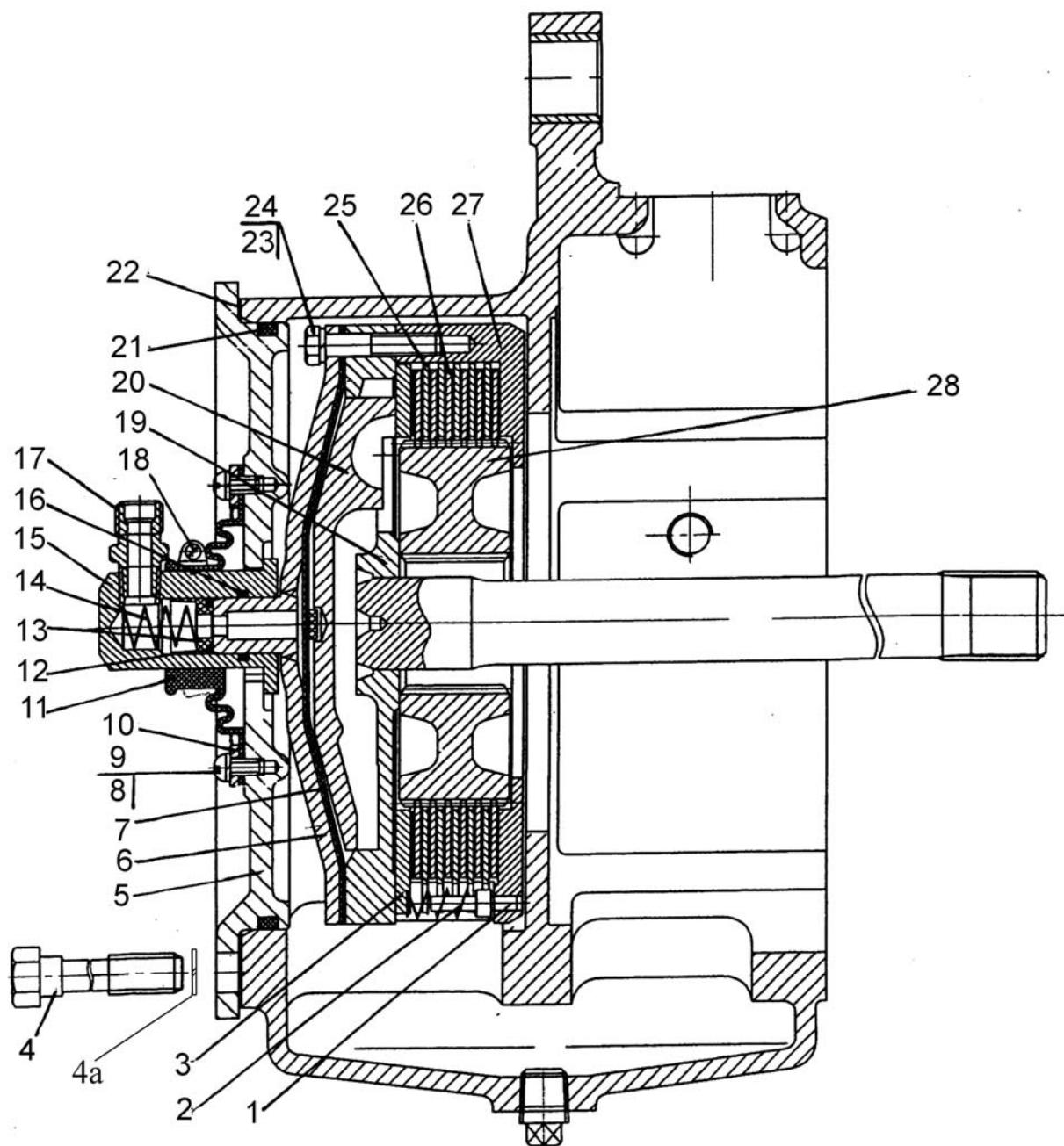
Рис. 24.4. Механизм блокировки дифференциала «мокрого» типа
