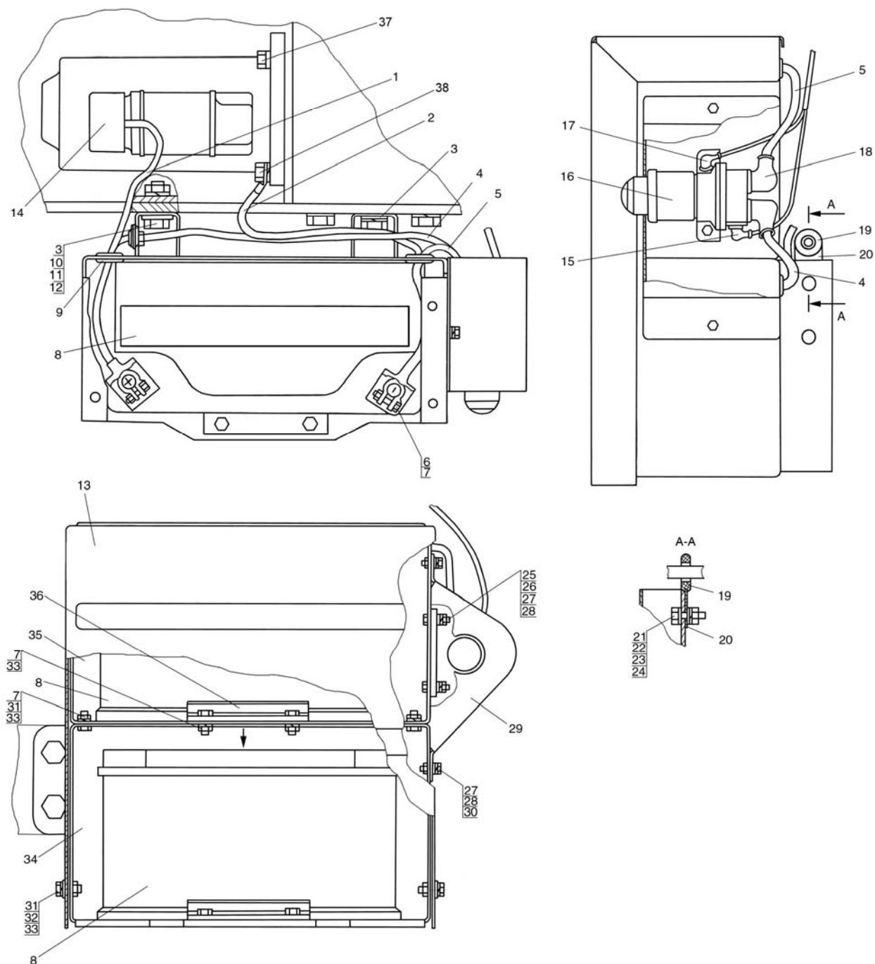
Рис. 37.6. Установка аккумуляторных батарей («БЕЛАРУС-1221В/1221В.2»)
