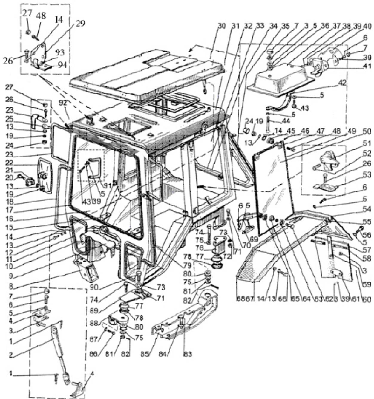
Рис. 67.1. Кабина трактора
