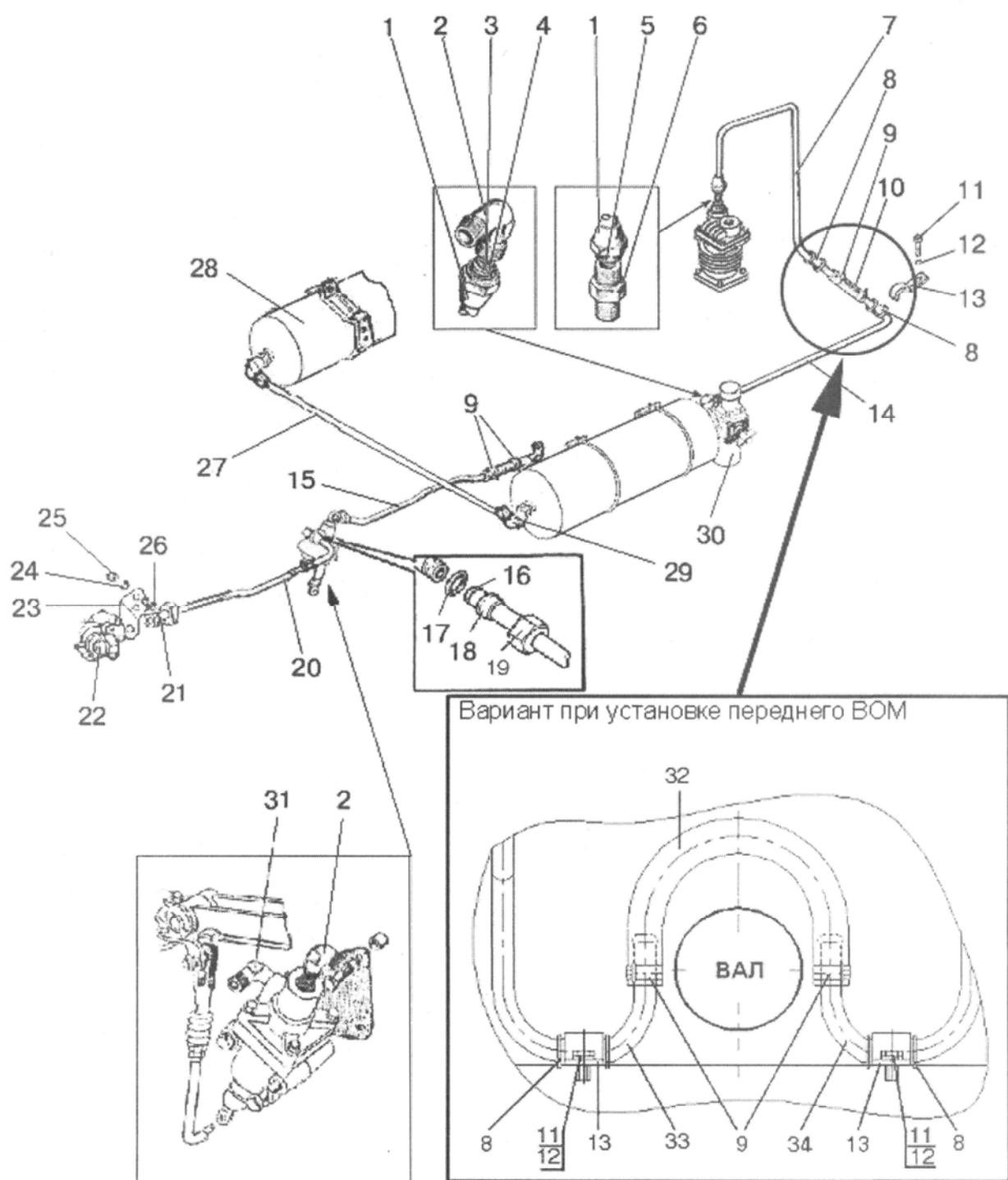
Рис. 35.7. Трубопроводы и арматура однопроводного пневмопривода тормозов прицепа
