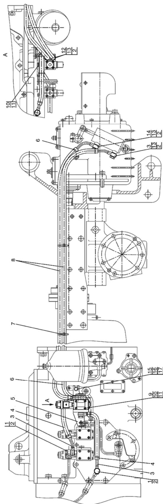
Рис. 42.7. Управление передним валом отбора мощности
