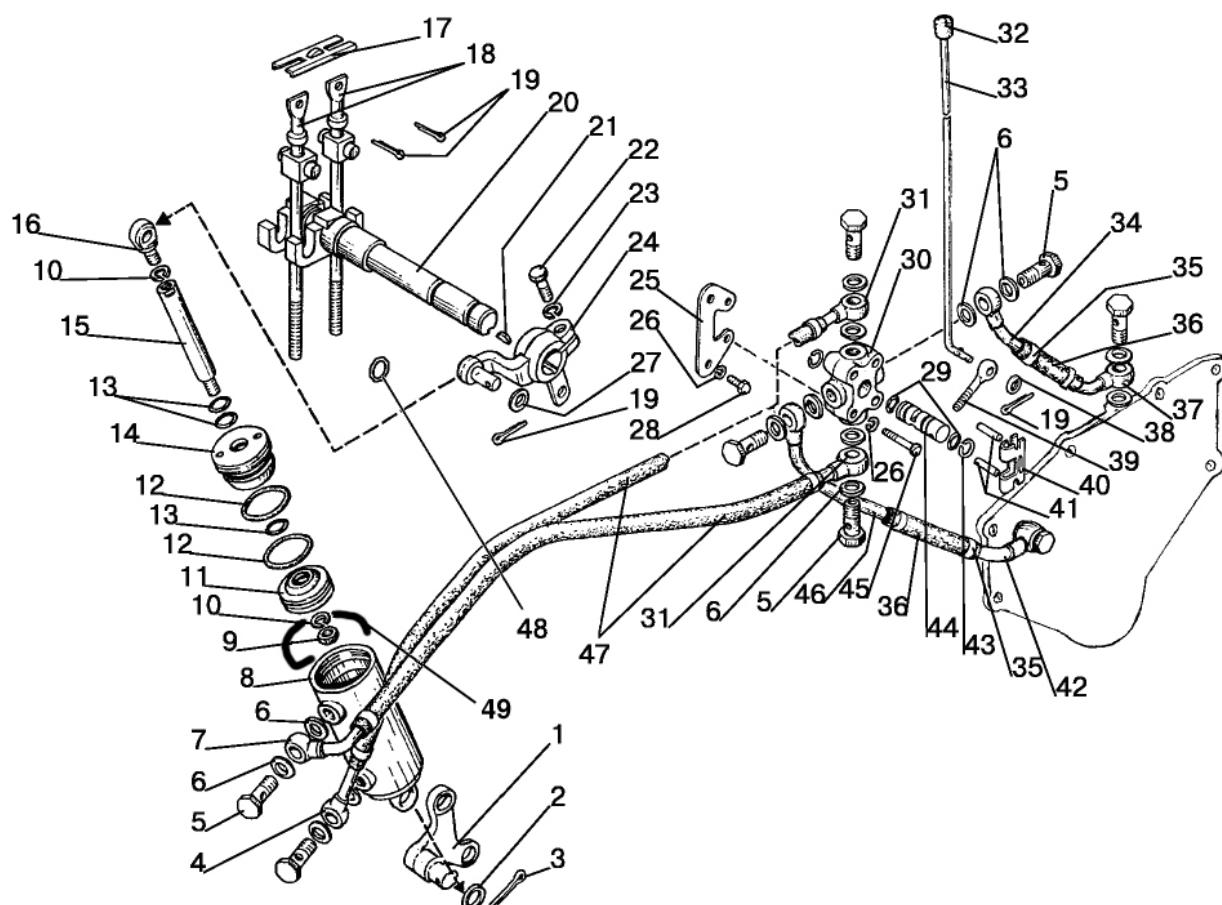
Рис. 42.5. Управление задним валом отбора мощности
