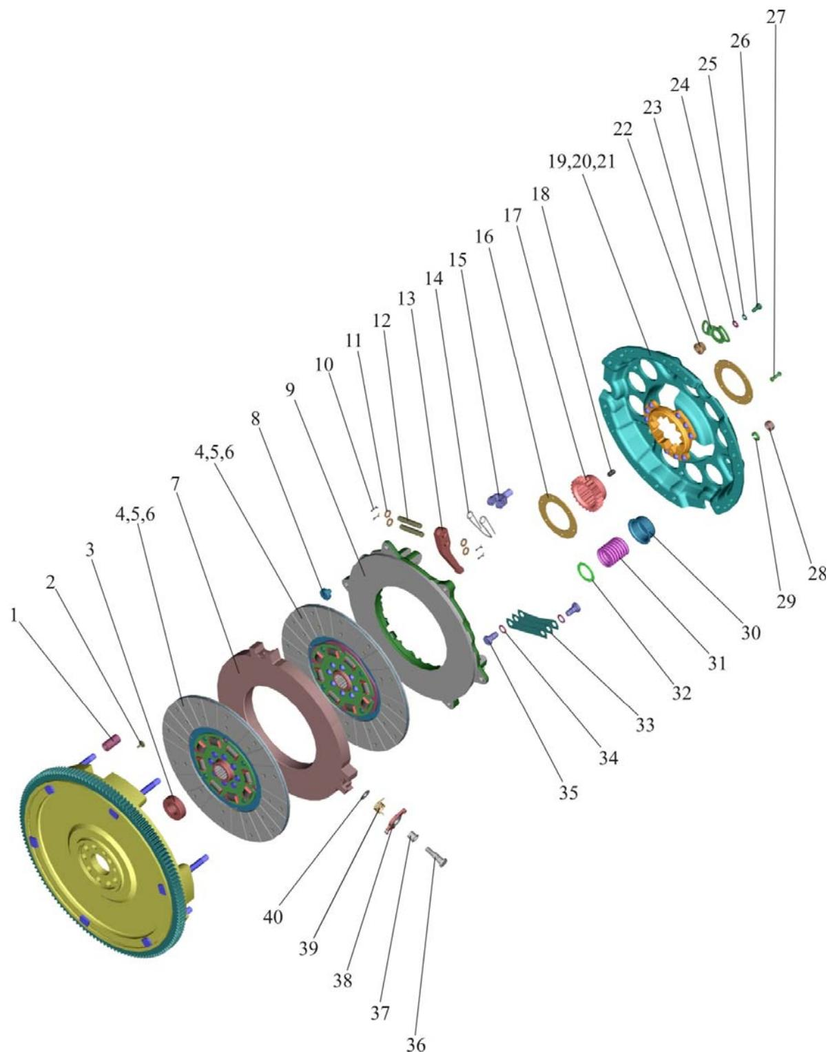
Рис. 16.1. Установка сцепления 260-1005009
