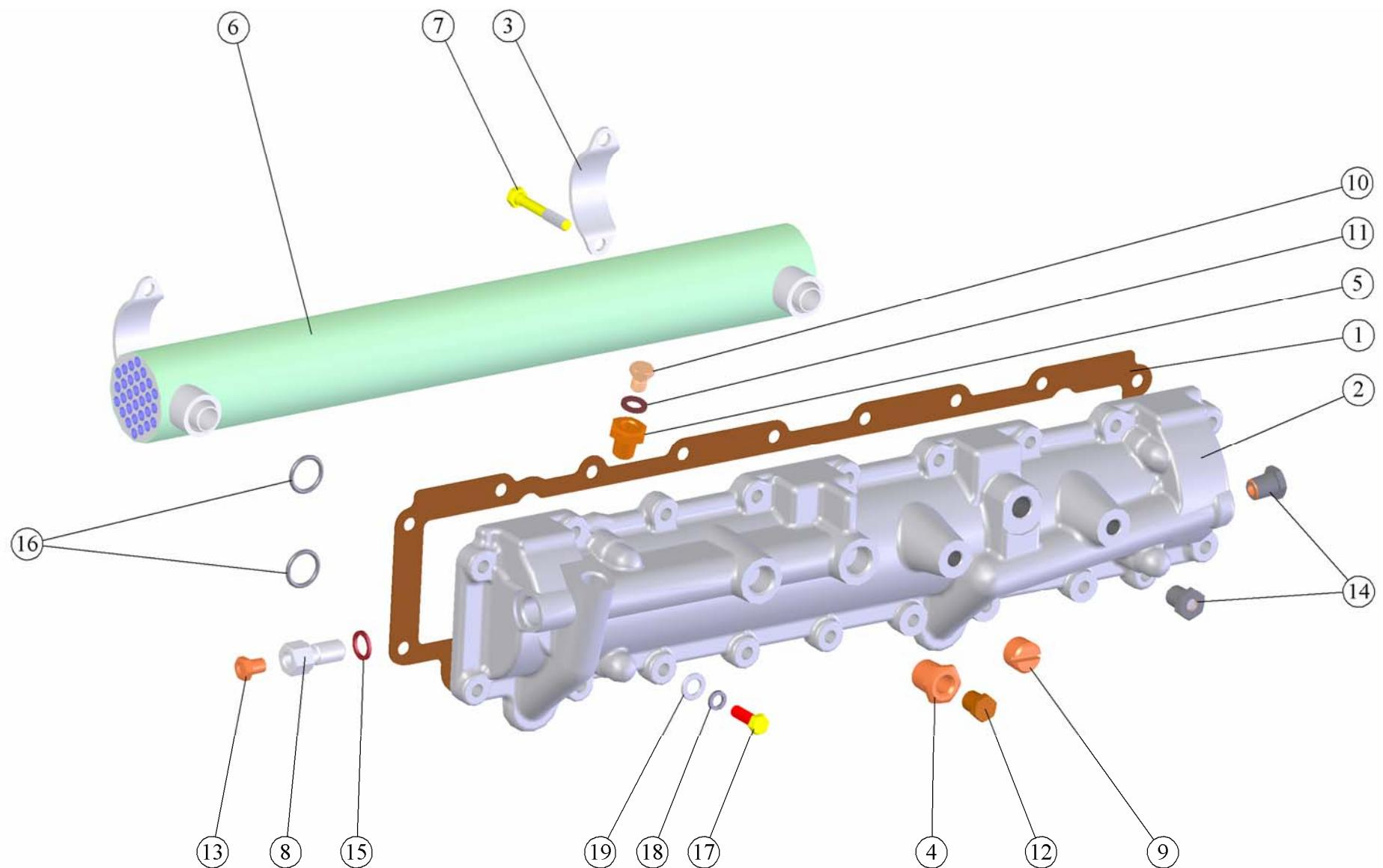
Рис. 16 Установка теплообменника.
