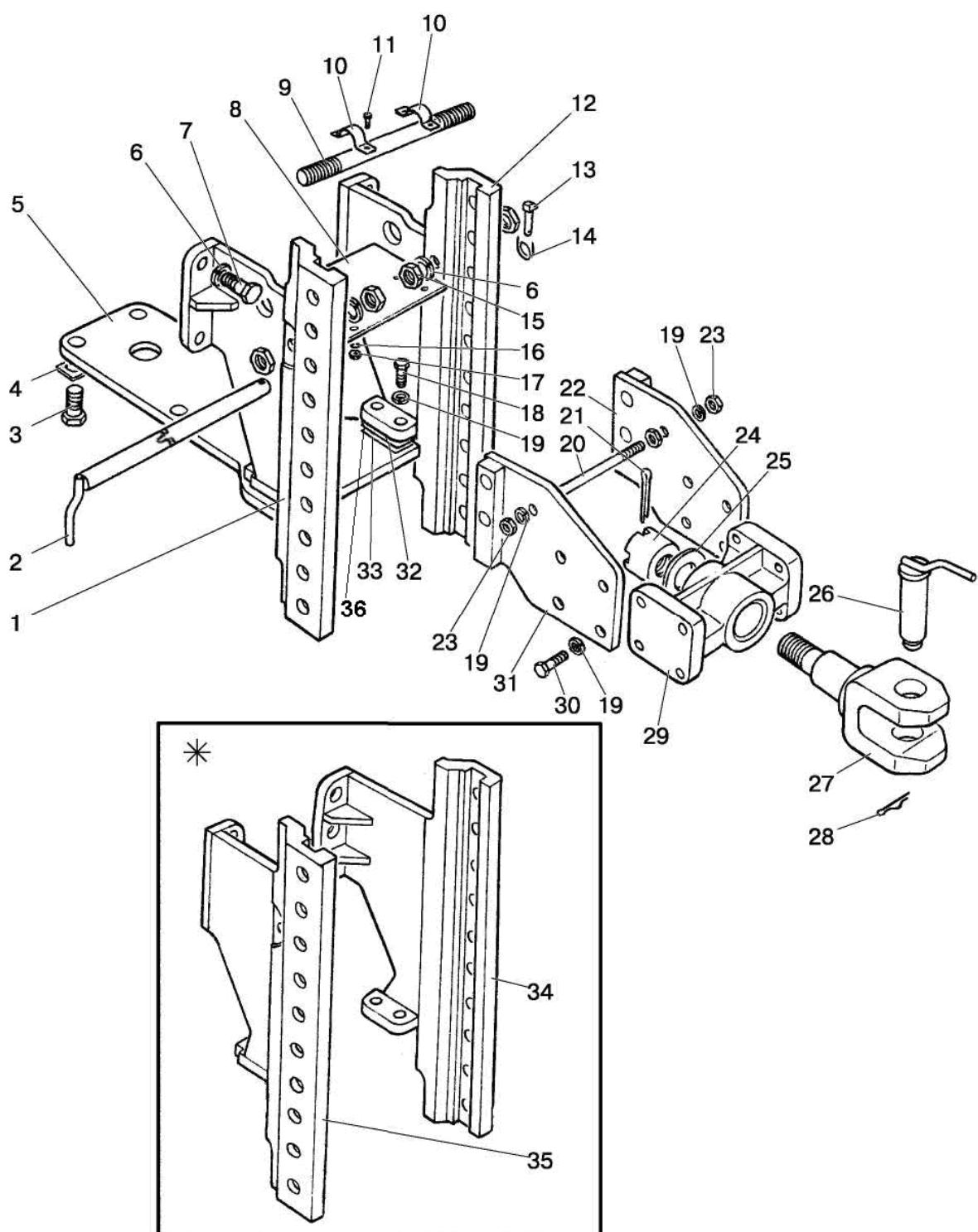
Рис. 27.1. Тягово-сцепное устройство (варианты комплектации)
