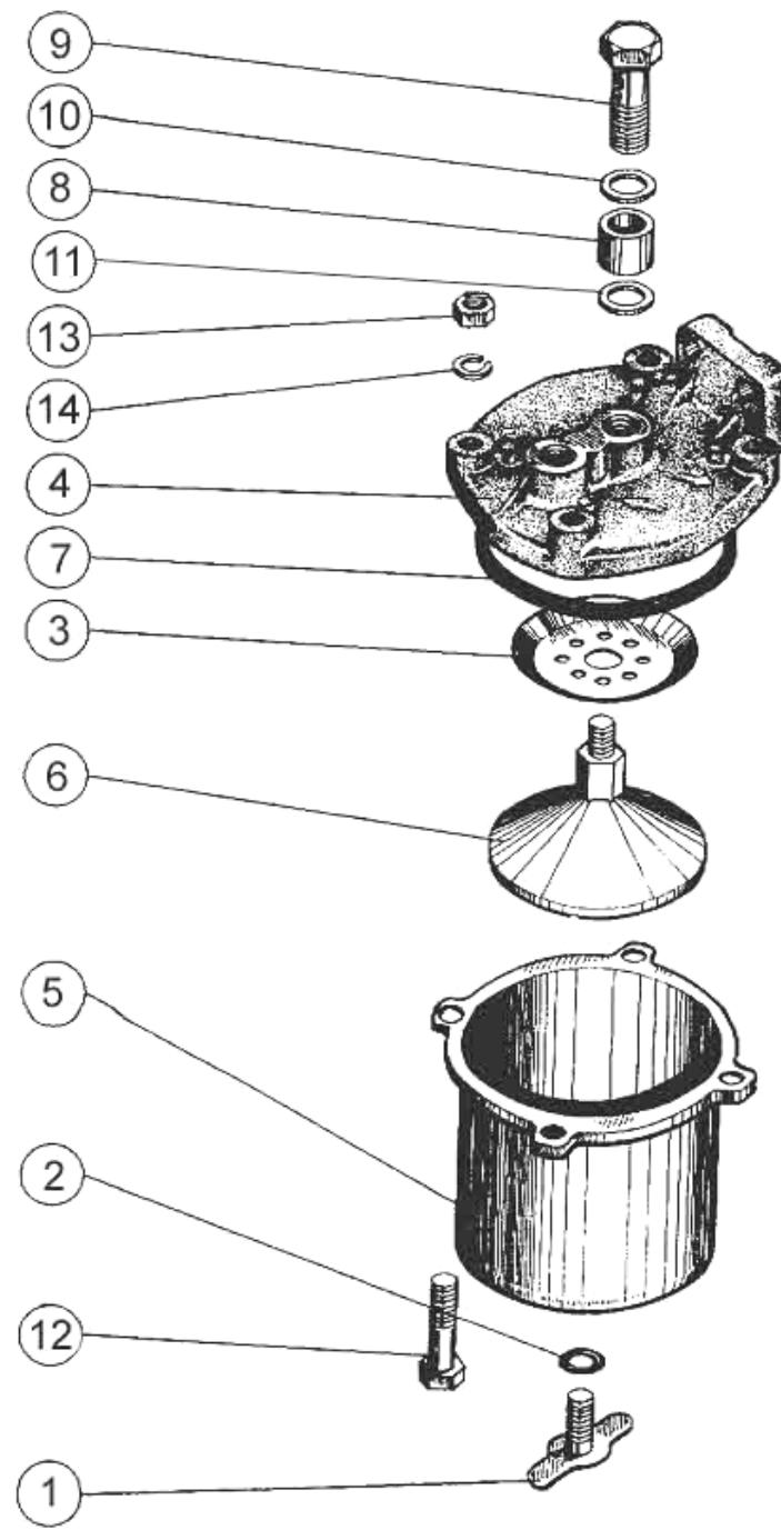
Рисунок 15. Фильтр топливный грубой очистки.
