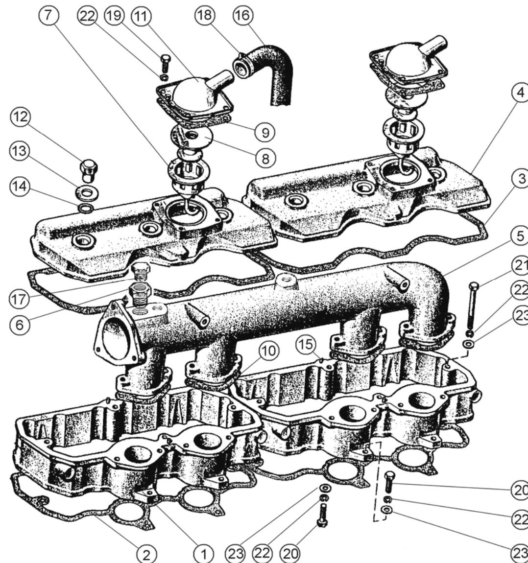
Рисунок 3. Крышки головок цилиндров, коллектор и сапуны
