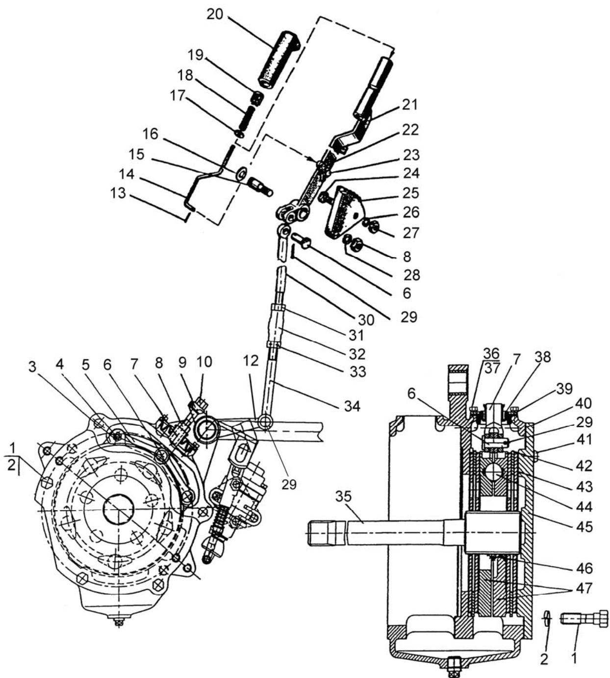
Рис.35.6. Тормоз стояночный. Управление стояночным тормозом
