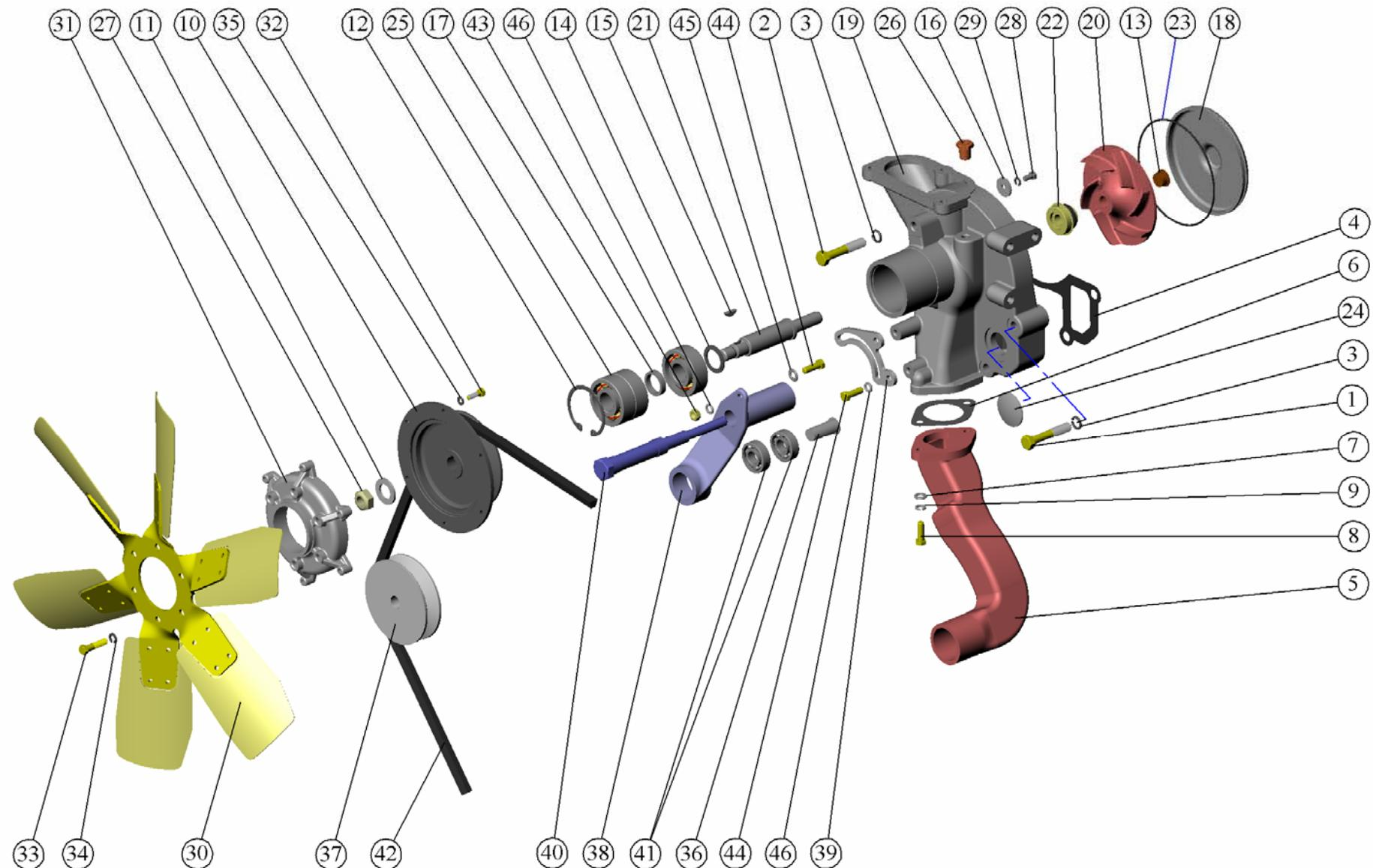
Рис. 13 Насос водяной. Установка вентилятора. Установка натяжителя.
