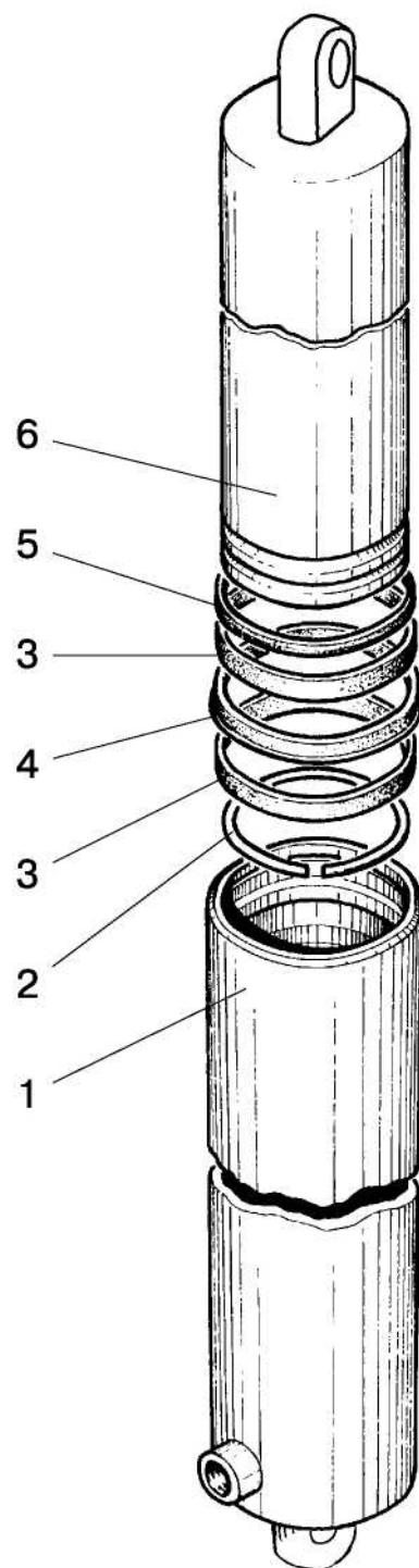
Рис. 46.13. Цилиндр гидроподъемника
