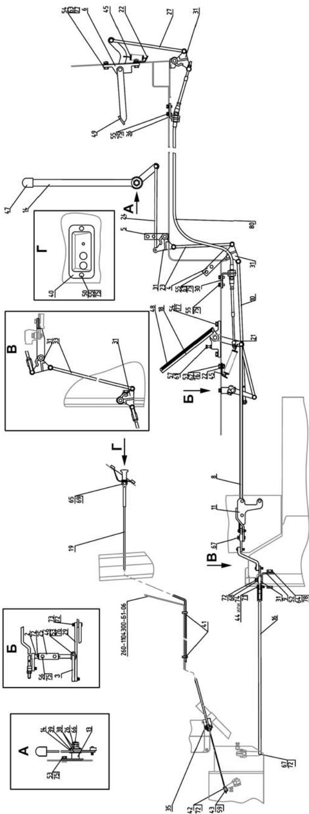
Рис. 11.1. Управление подачей топлива (реверс)
