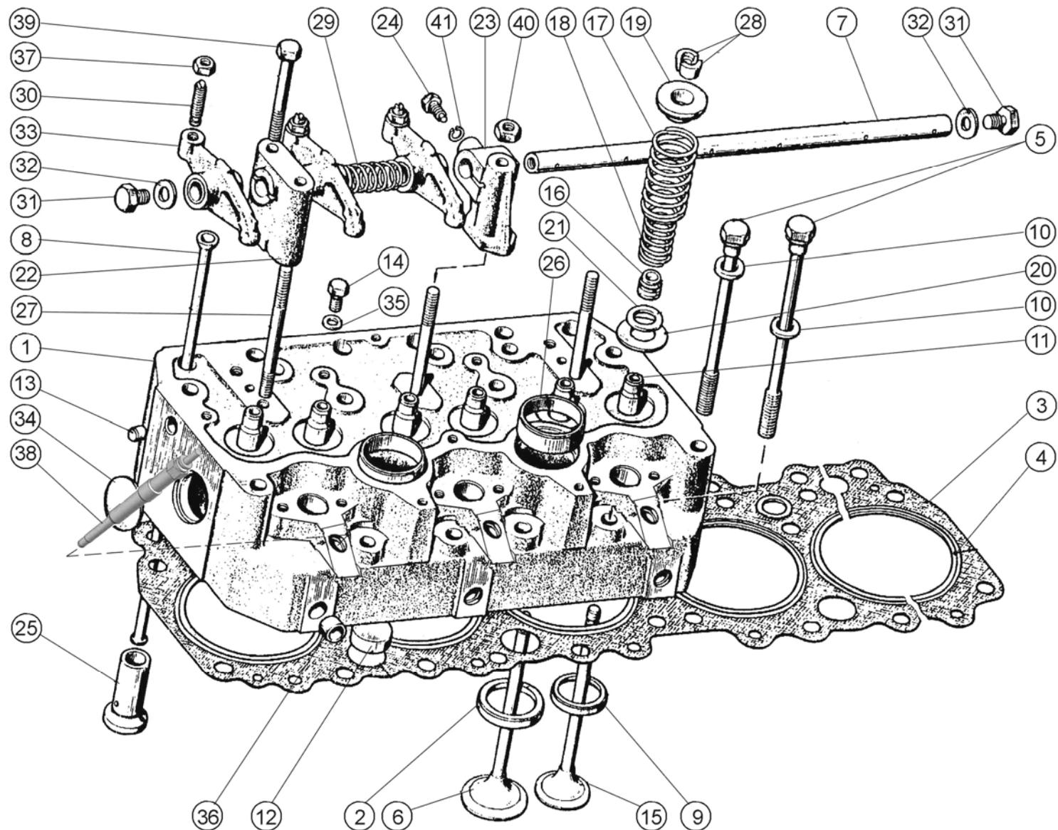
Рисунок 2. Головка цилиндров. Клапаны и толкатели клапанов.
