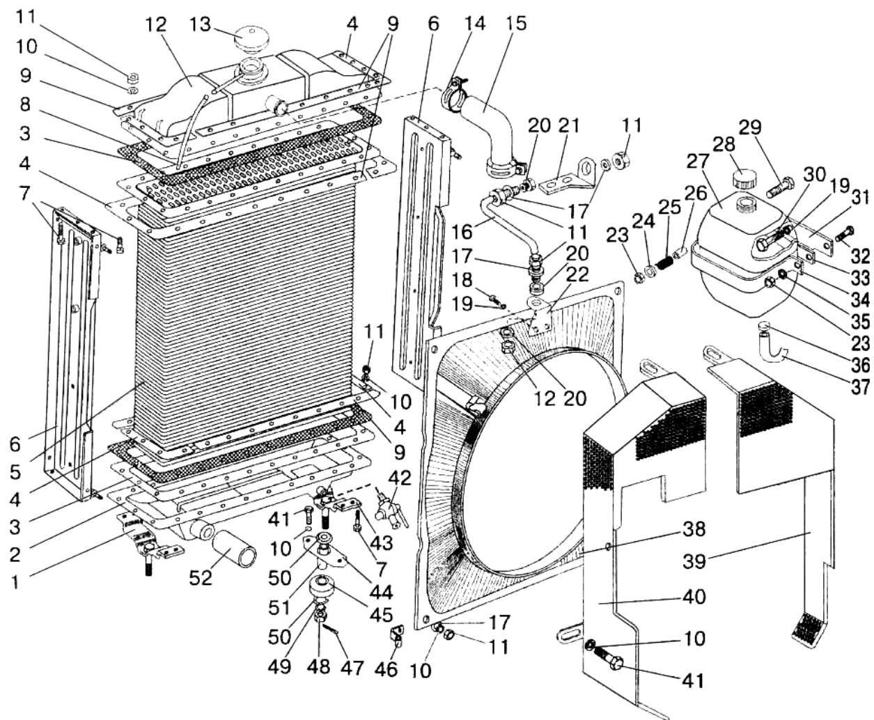
Рис. 13.2 Радиатор водяной (для трактора «БЕЛАРУС-1221.3/1221В.3»)
