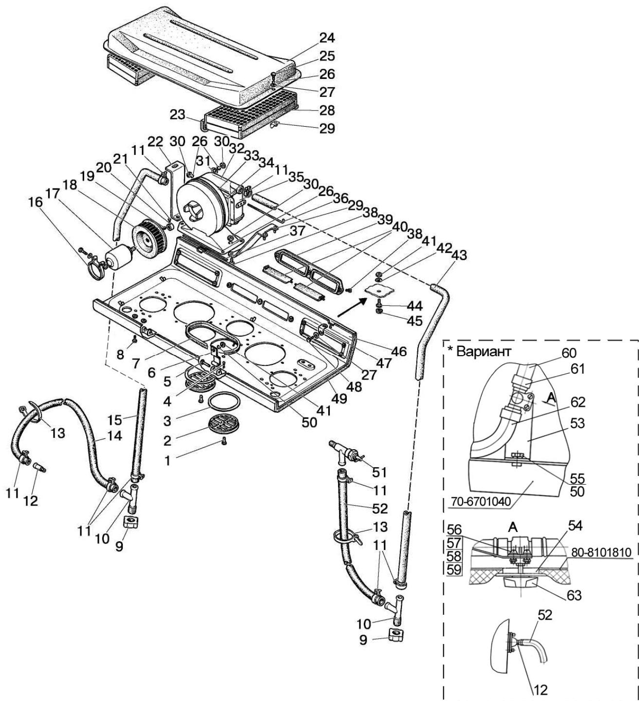
Рис. 81.1. Установка отопителя
