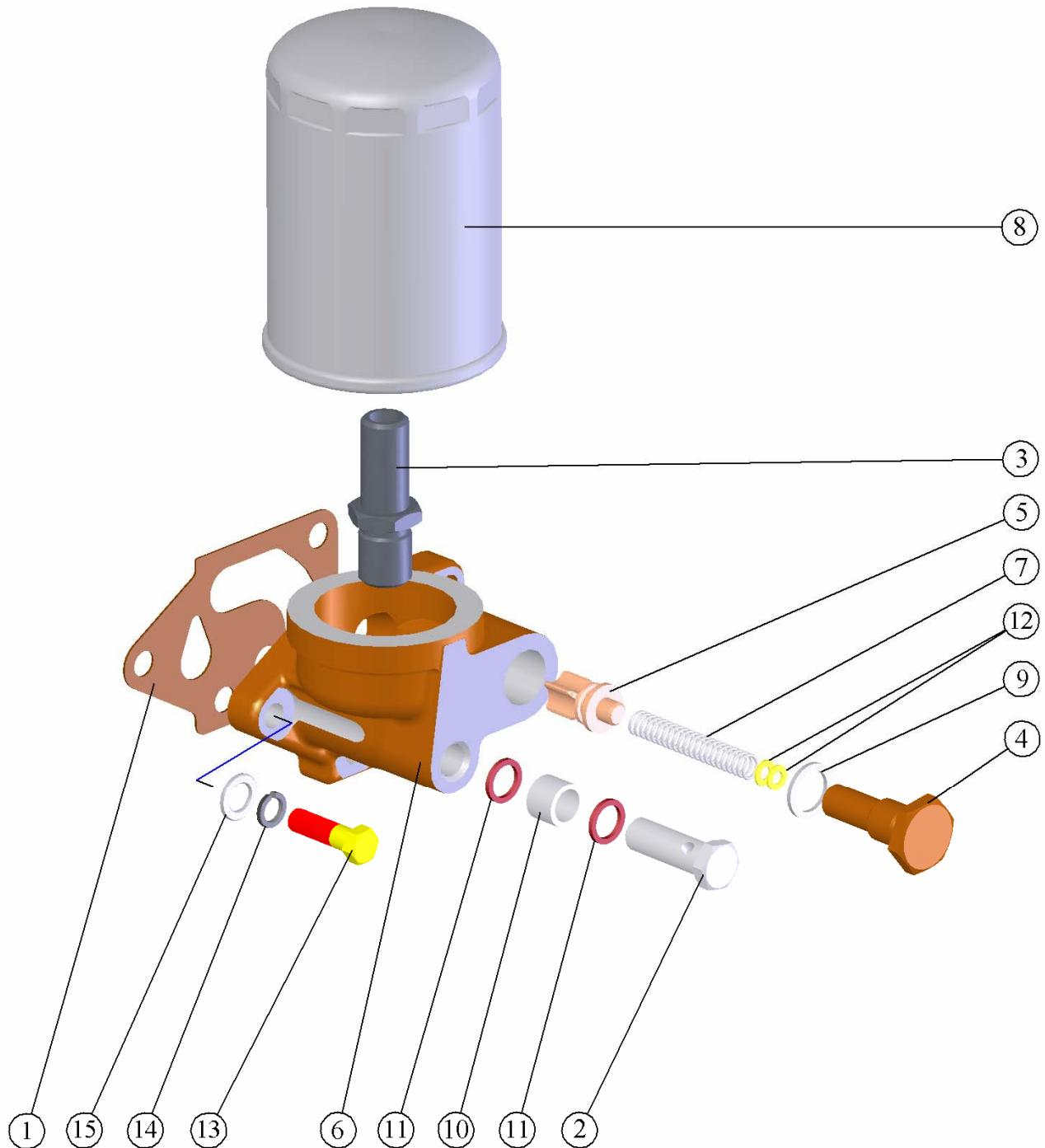
Рис. 17 Установка фильтра очистки масла.
