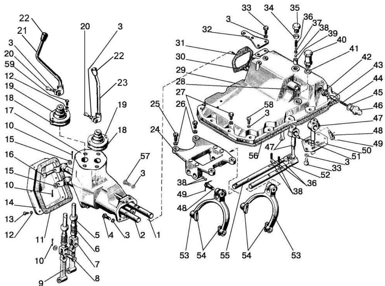
Рис. 17.6. Механизм управления коробкой передач
