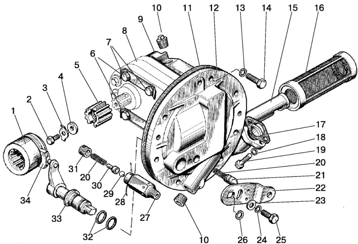
Рис. 17.14. Привод насосов
