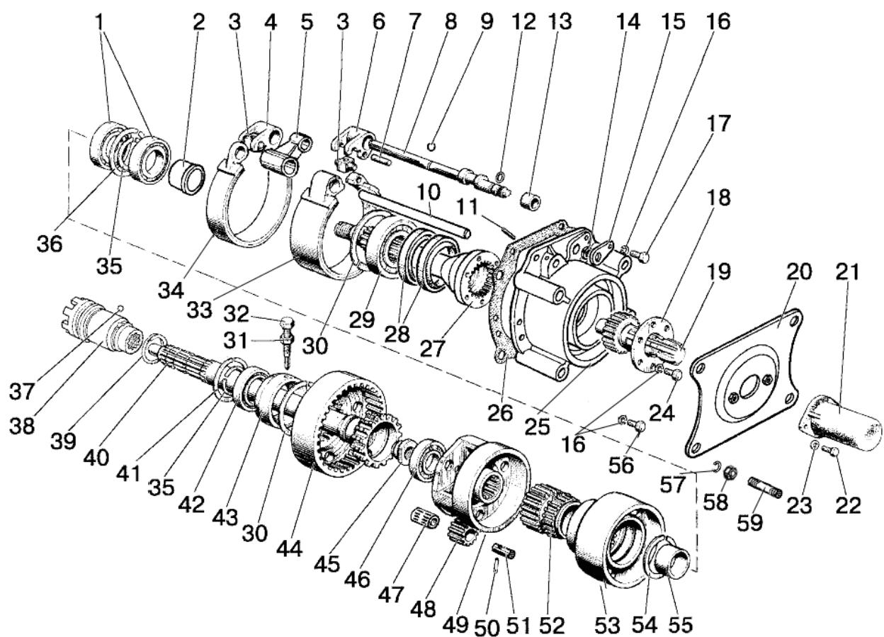
Рис. 42.1. Вал отбора мощности задний
