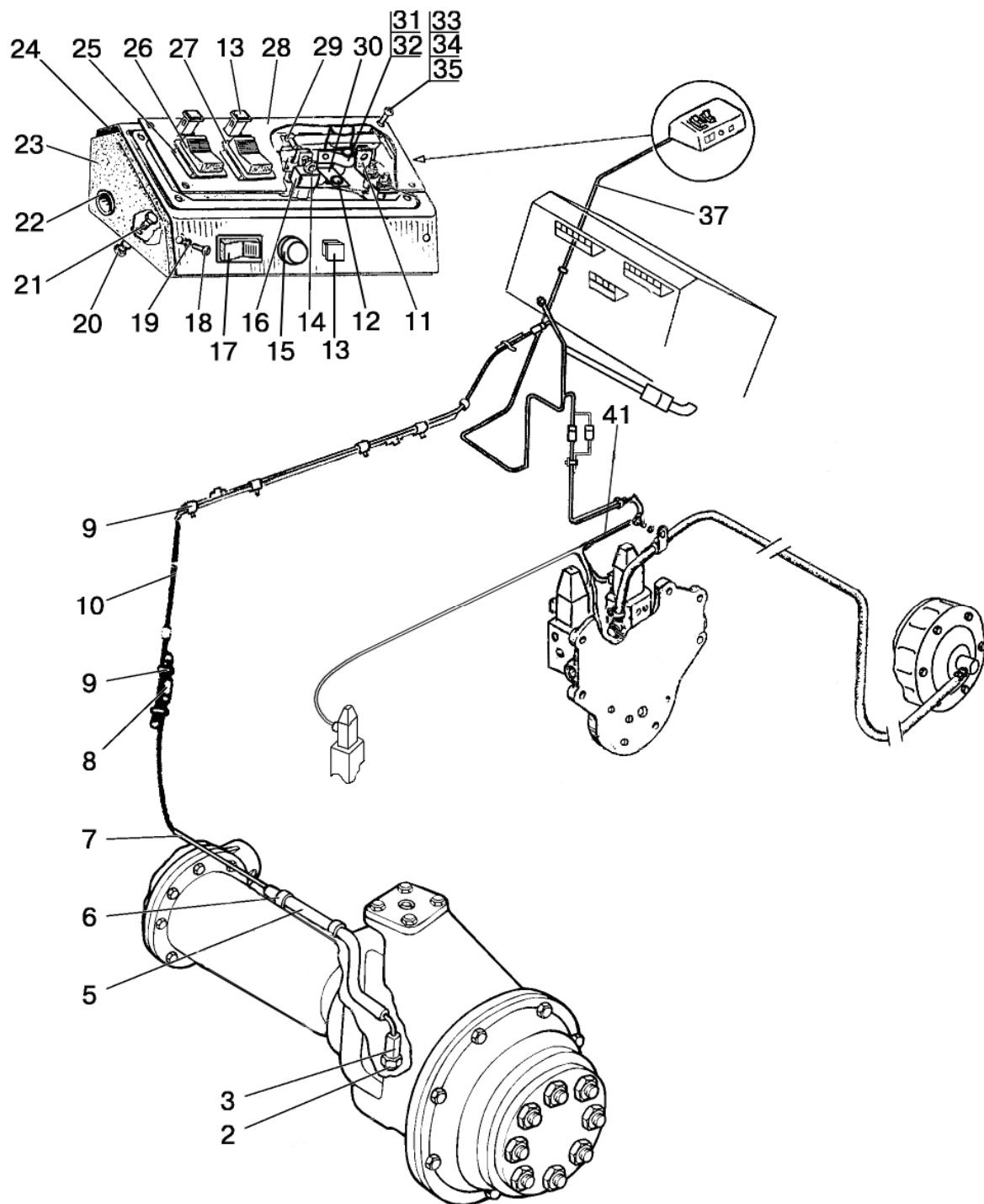
Рис. 87.2. Управление ПВМ, БД заднего моста и передним ВОМ (1221-8700210-Д)
