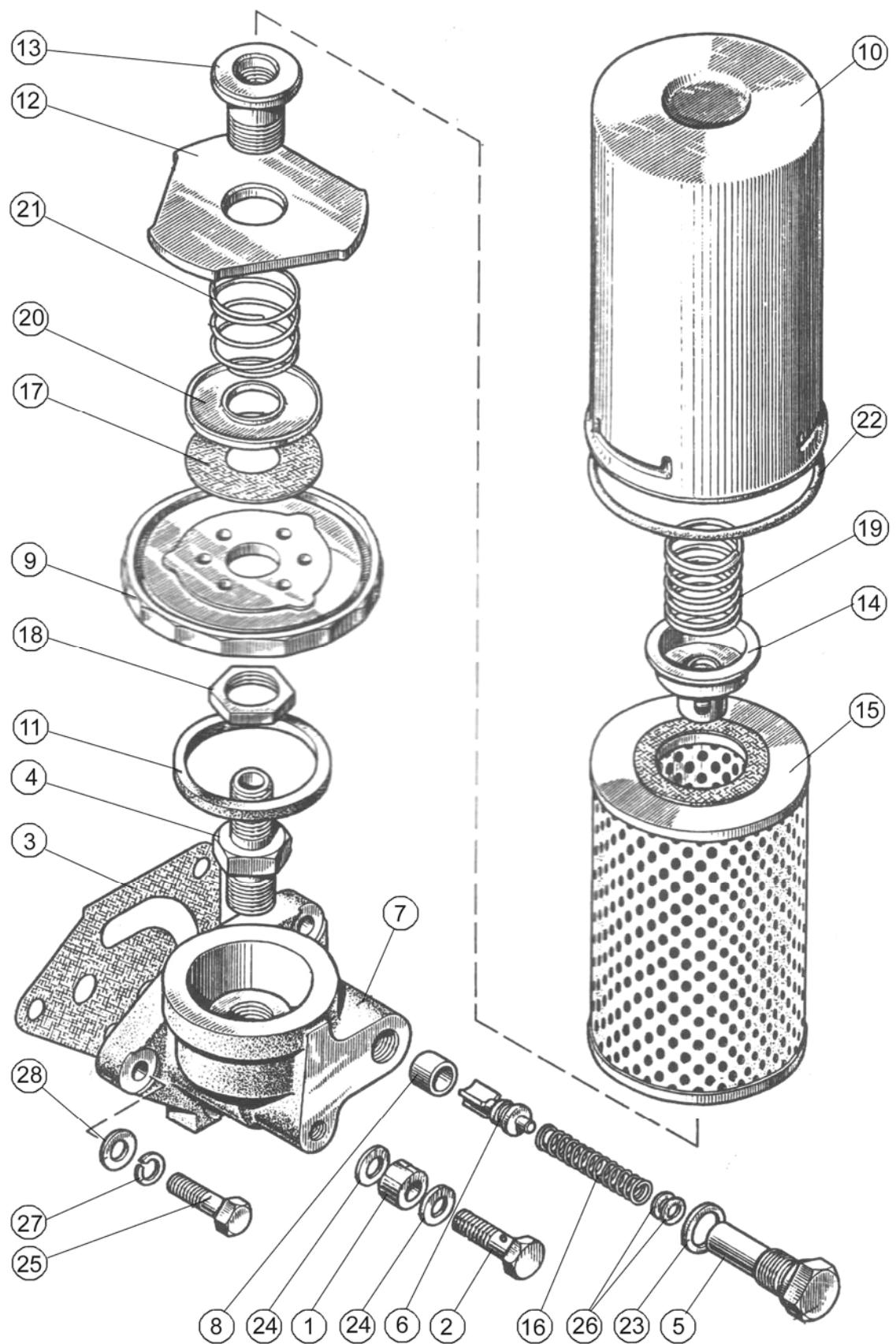
Рисунок 10. Установка масляного фильтра
