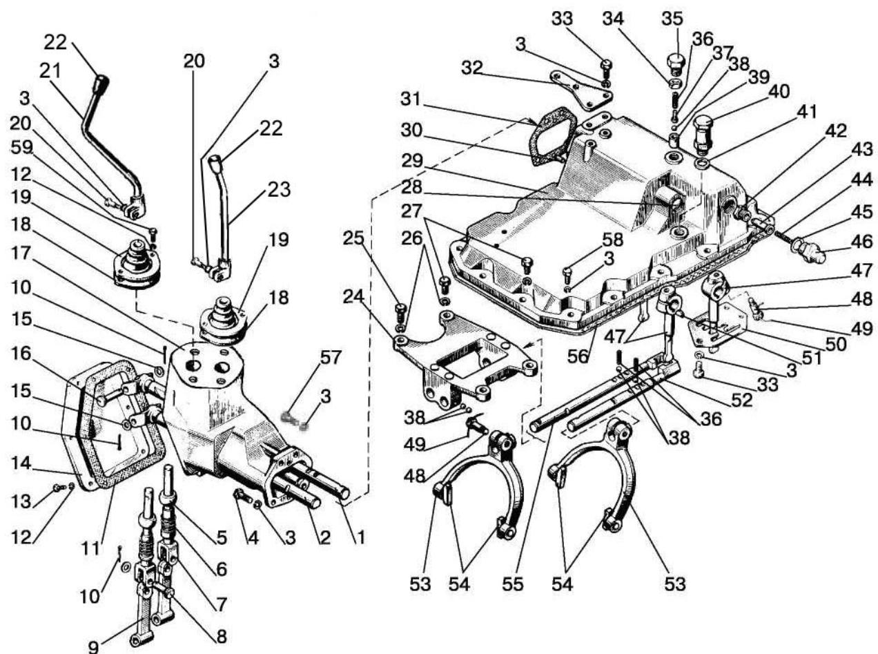
Рис. 17.6. Механизм управления коробкой передач
